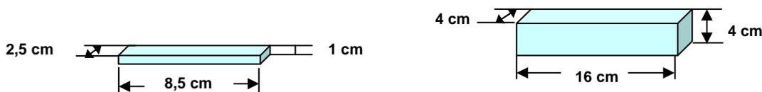
Après une cure de conservation de 28 jours sous eau ou à 100% HR, les éprouvettes sont conservées sous film plastique fermé hermétiquement, à  $21\pm 1^{\circ}\text{C}$  et  $65\pm 5\%$ .
