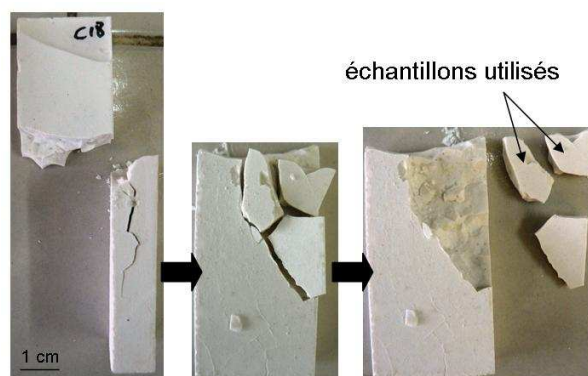
Figure 18 : échantillonnage des éprouvettes pour la coloration PAS
