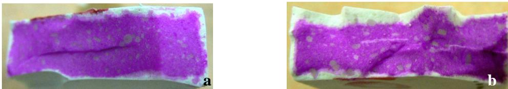
**Photo 4 : Résultats obtenus pour une éprouvette 1x2,5x8,5 cm conservée sous eau, séchée – a. coloration après 24 h de carbonatation – b. coloration après 48h de carbonatation**
