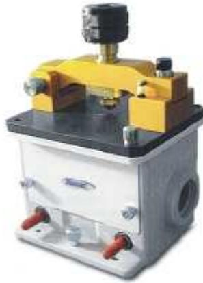
**Figure 75 : Dispositif ATR utilisé à l'EMSE**
