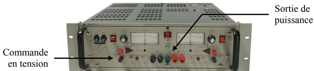
*Figure V.5 : Amplificateur de puissance BOP 20-20*
