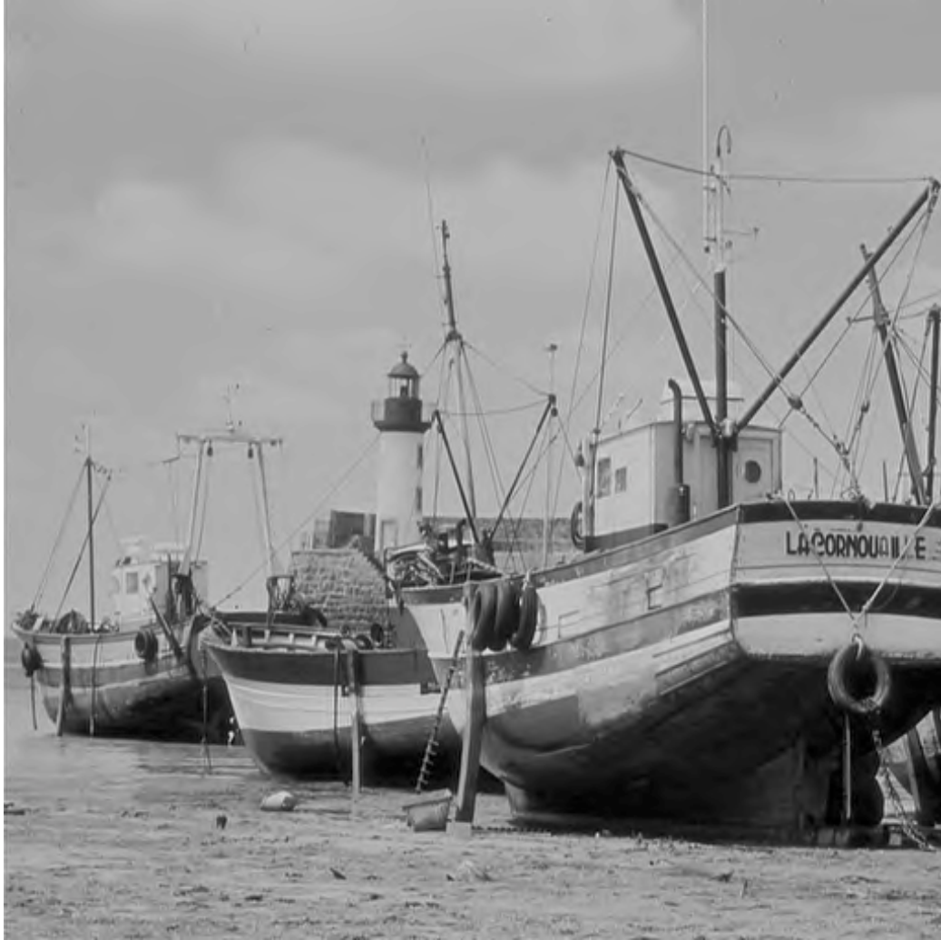
Fig. 6.4: Décodage du flux 2 et reconstruction de l'image bateau 512×512 (débit 0,8 bits/pixels pour un PSNR de 37,02).
