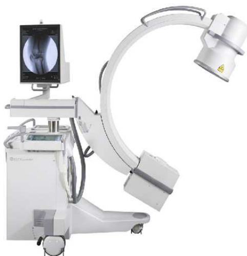
FIG. 1.2 – Un arceau mobile, ou C-ARM, est un dispositif d'imagerie par rayons X permettant d'acquérir des images au bloc opératoire, en continu, ou à volonté. A l'une des extrémités du bras, on trouve une source de rayons X, et à l'autre, un détecteur [Image General Electrics]
