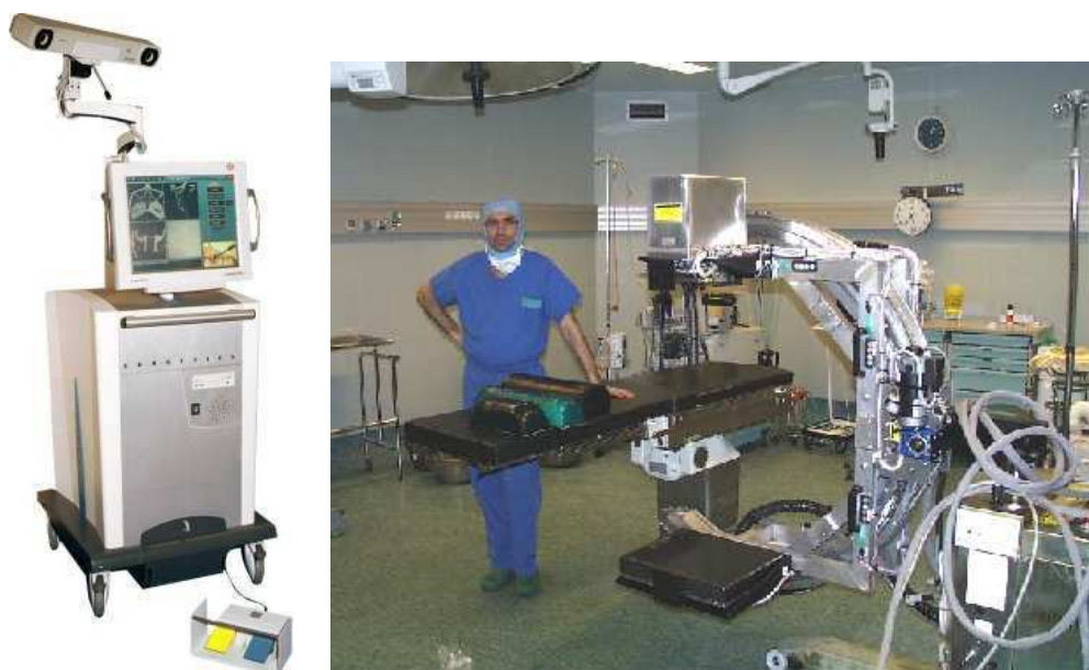
FIG. 1.14 – Le matériel autour duquel s'articule le projet MI3, contexte de ce travail de thèse : la station de navigation Surgetics de l'entreprise Praxim (à gauche), et le C-ARM interventionnel dans lequel un capteur plan dynamique de l'entreprise Trixell a été intégré.
