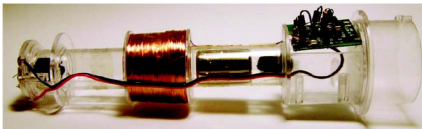
Figure 1-6 Lampe torche utilisant un générateur électromagnétique [1]
