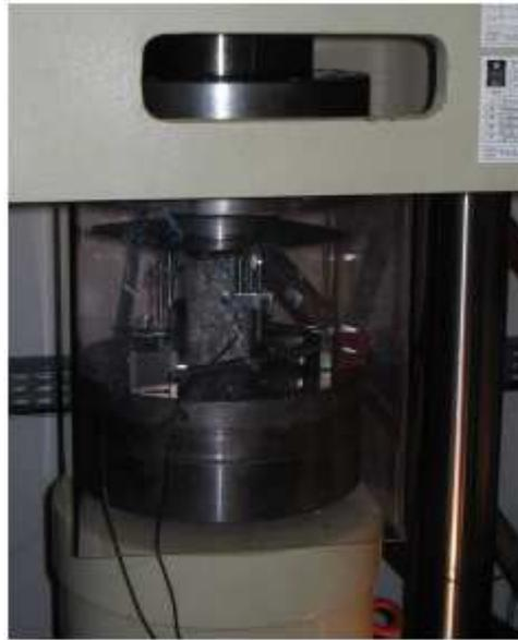
Figure 2-24 : Vue d'ensemble d'un essai de compression simple
