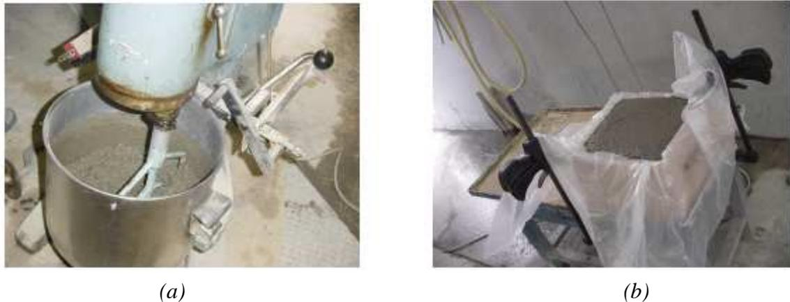
Figure 2-6 : Mise en œuvre du coulage de béton
