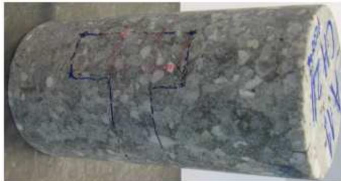
Figure 2-11 : Echantillon de béton R30A7 (dimension 7 x 14 cm) après préparation de la surface latérale (“échantillon préparé”)
