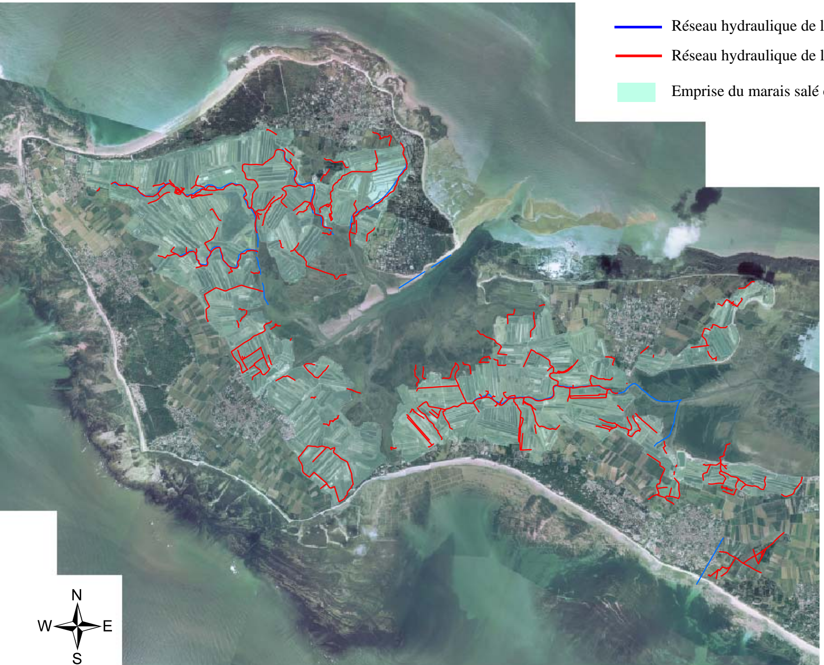
Figure 23. Représentation cartographique du réseau hydraulique du marais salé endigué de l'île de Ré
