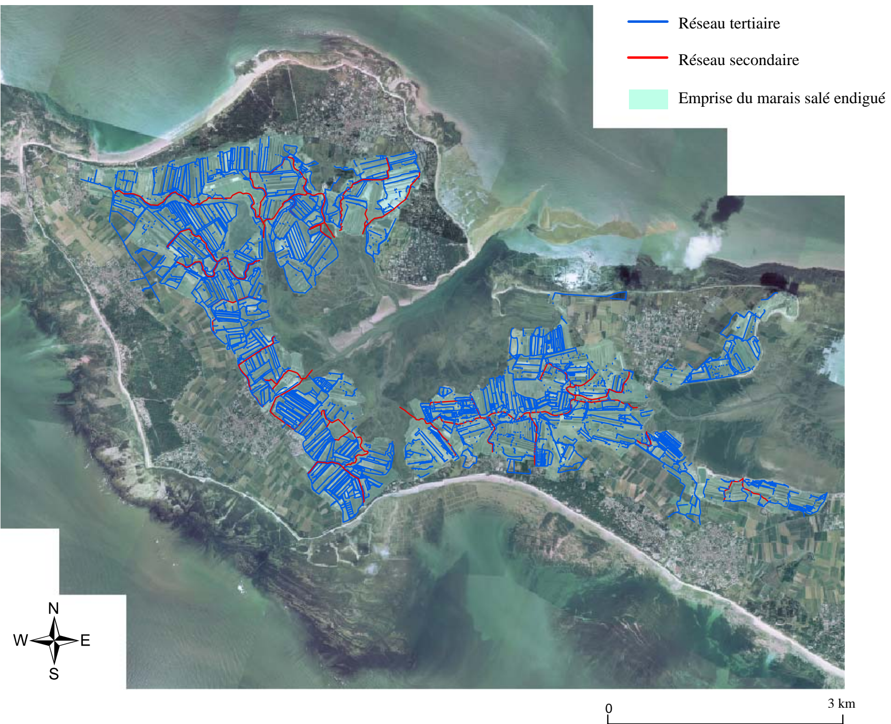
Figure 28. Hiérarchie du réseau hydraulique du marais salé endigué de l'île de Ré.
