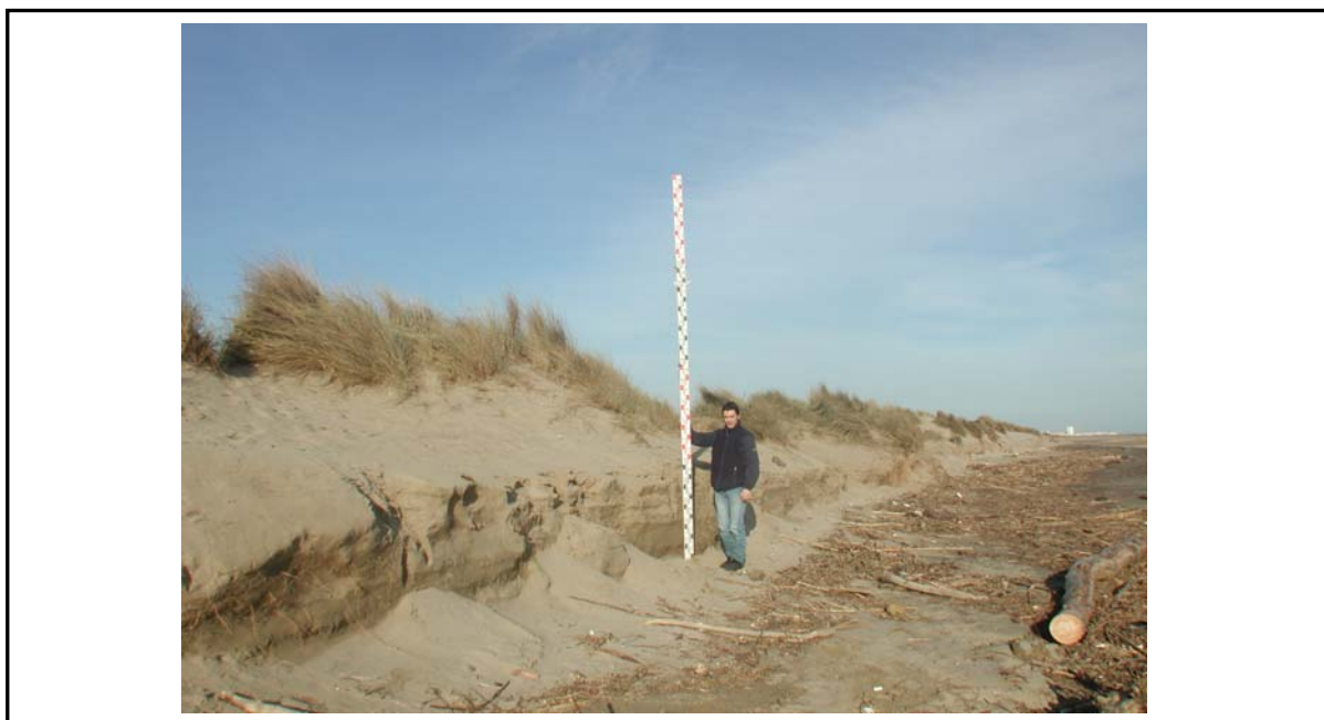
Photo 3 : érosion du cordon dunaire (98 cm) mesuré à Grau-de-Vendres le lendemain de la surcote de 80 cm du 4/12/2003 (Ullmann, 2003).
