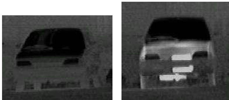
Figure 4.8: En infra-rouge, les modifications thermiques influencent grandement l'apparence des objets. A gauche: AX moteur froid. A droite: AX moteur chaud.
