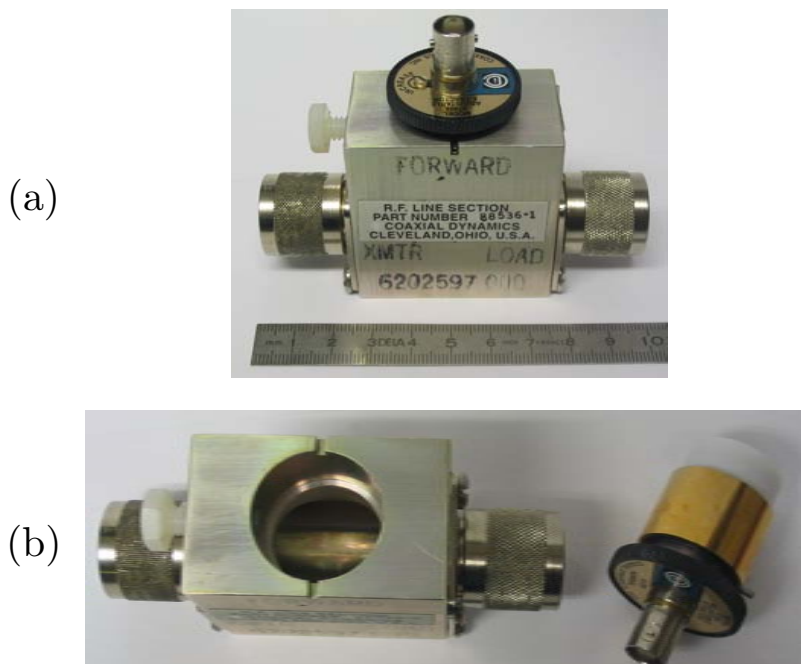
FIG. 2.10 – Photographies de la sonde de tension montée (a) et démontée (b).
