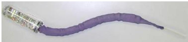
**Figure 1.7:** – Le robot Lamproie : Robot à base de matériaux à mémoire de forme (extrait de [Ayers *et al.*, 2000])
