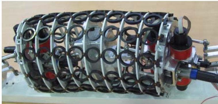
**Figure 1.13:** – Structure mécanique permettant de soutenir la peau en latex
