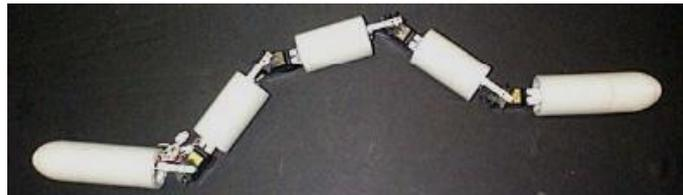
**Figure 1.6:** – Le robot REEL2 : Anguille à 5 corps (extrait de [McIsaac et Ostrowski, 1999])
