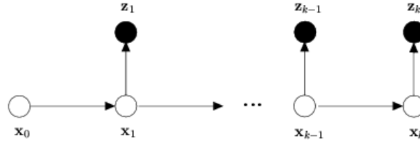
FIG. 0.1: Graphe de dépendance orienté de la chaîne de Markov cachée constituée des processus \mathbf{x}_{0:k} et \mathbf{z}_{1:k}
