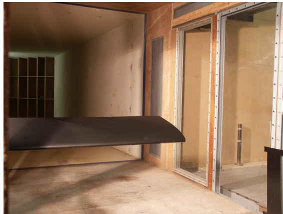
FIG. 6.7 – Profil NACA 0015 ( \lambda = 3 ) installé, sans plaques de garde, dans la veine de la Soufflerie Béton
