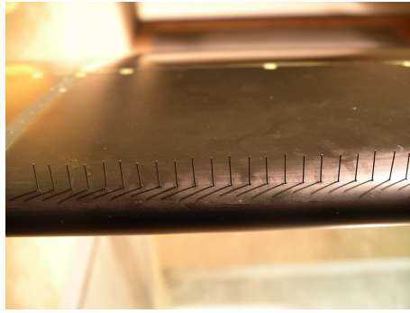
FIG. 8.14 – La maquette et les micro-cylindres introduits dans les orifices des microjets
