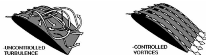
FIG. 3.3 – Contrôle de la vortacité grâce à des riblets ou des systèmes LEBU
