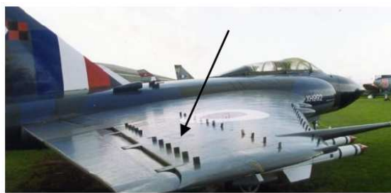
FIG. 3.2 – Générateurs de vortex installés sur un Gloster Javelin FAW.8 (XH992)
