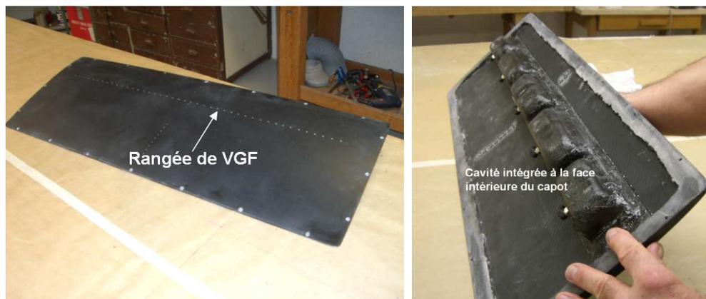
FIG. 6.38 – L'actionneur de type VGF
