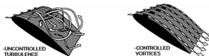
FIG. 3.3 – Contrôle de la vorticit e gr ace   des riblets ou des syst emes LEBU
