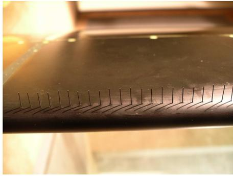
FIG. 8.14 – La maquette et les micro-cylindres introduits dans les orifices des microjets
