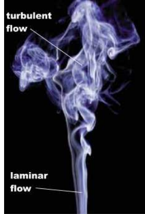
FIG. 2.1 – Visualisation de la différence entre un écoulement laminaire et un écoulement turbulent
