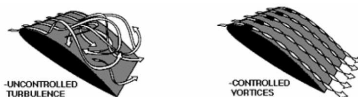
FIG. 3.3 – Contrôle de la vorticit e gr ace  a des riblets ou des syst emes LEBU
