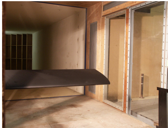
FIG. 6.7 – Profil NACA 0015 ( \lambda = 3 ) installé, sans plaques de garde, dans la veine de la Soufflerie Béton
