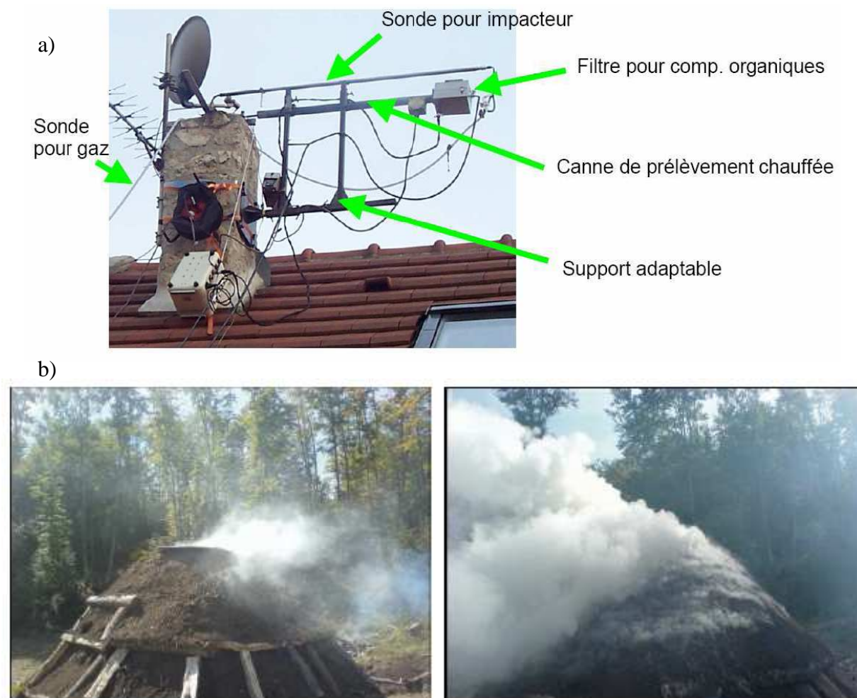
Figure III-1.7. a) Photographie de système de prélèvements de gaz et de particules lors de l'étude sur l'évaluation de l'impact des appareils de chauffage à bois sur la qualité de l'air intérieur et extérieur menée par l'INERIS et le LCME. [source : INERIS 2007a]. b) Charbonnière à Saint Julien en Vercors au démarrage (à gauche) et en régime nominal (à droite).[source : Deutsch 2008]
