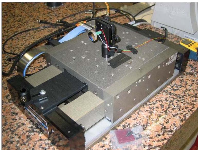
Figure 5-24 : Platine de déplacement avec le miroir mobile monté sur l'actionneur piézoélectrique
