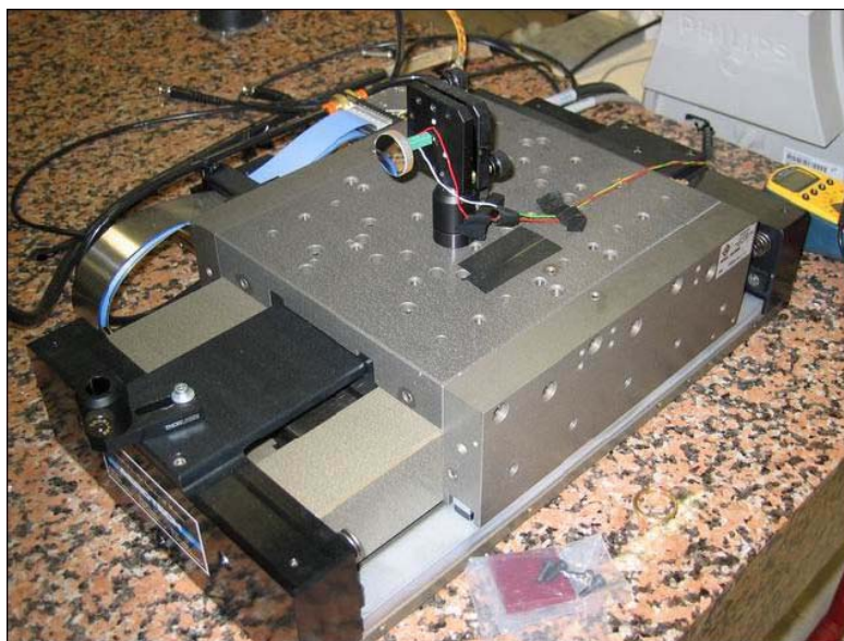
Figure 5-24 : Platine de déplacement avec le miroir mobile monté sur l'actionneur piézoélectrique
