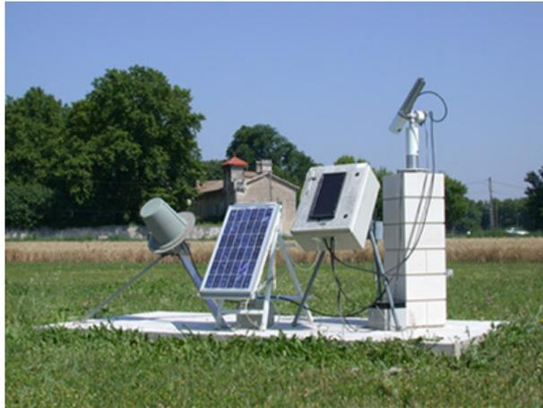
FIG. A.1 – Un site de mesure du réseau AERONET (Avignon, France).
