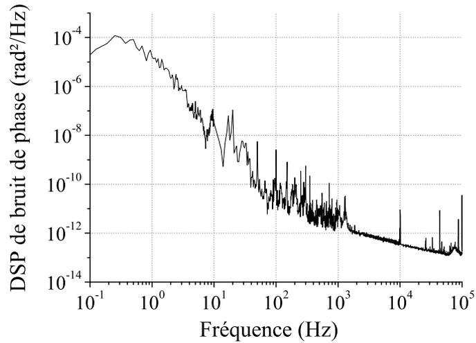
FIG. 5.4 – Densité spectrale de bruit de la différence de phase entre les deux faisceaux en polarisations croisées, induit par les fluctuations de longueur optique dans la fibre. Le bruit est essentiellement d'origine acoustique entre 1 Hz et 1 kHz. Au-delà, il semble que nous mesurons plutôt le bruit du photoconducteur.
