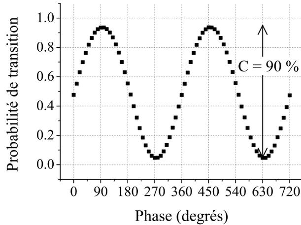
FIG. 4.5 – Franges d’interférences obtenues avec les faisceaux Raman co-propageants, en balayant la différence de phase entre les lasers. L’intervalle entre les deux impulsions  $\pi/2$  est  $T = 100$  ms, et la durée d’une impulsion est  $\tau_{\pi/2} = 8 \mu\text{s}$ .
