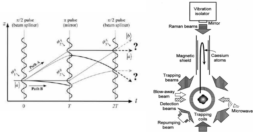
FIG. 1.3 – Gauche : schéma de l'interféromètre à ondes de matière obtenu avec des transitions Raman. L'accélération  $g$  déforme les trajectoires par rapport aux ondes lasers. La mesure de  $g$  est déduite de la probabilité de transition d'un état d'impulsion à l'autre. Droite : fontaine atomique utilisée pour le gravimètre de Stanford. (Images tirées de [33])
