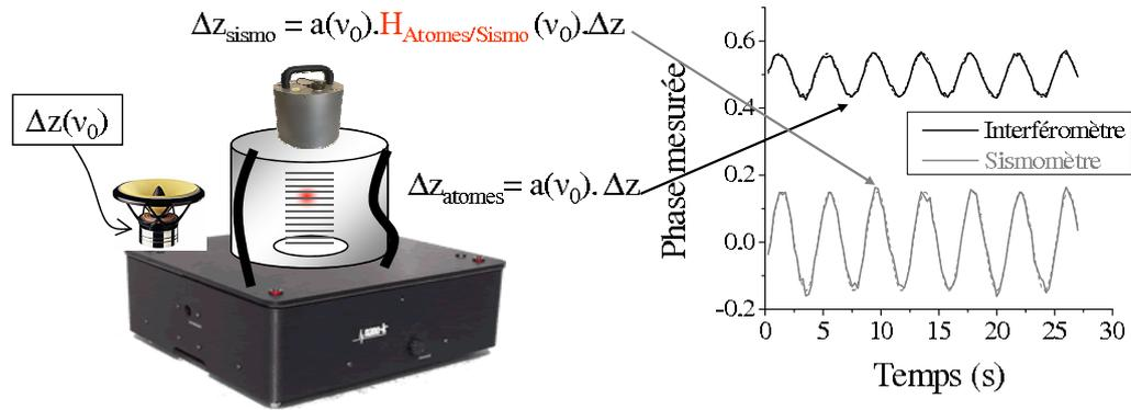
FIG. 5.22 – Mesure directe de la fonction de transfert directe interféromètre/sismomètre. Un déplacement vertical  $\Delta z$  du haut-parleur à la fréquence  $\nu_0$  induit un déplacement  $a \cdot \Delta z$  de la plateforme ( $a$  est la fonction de transfert entre le haut-parleur et la plateforme),  $a \cdot \Delta z \cdot H_{\text{atomes}}$  pour l'interféromètre, et  $a \cdot \Delta z \cdot H_{\text{sismo}}$  pour le sismomètre.
