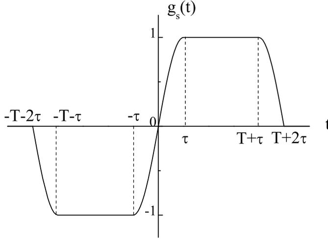
FIG. 2.3 – Fonction de sensibilité de la phase de l'interféromètre à un saut de phase infini-
