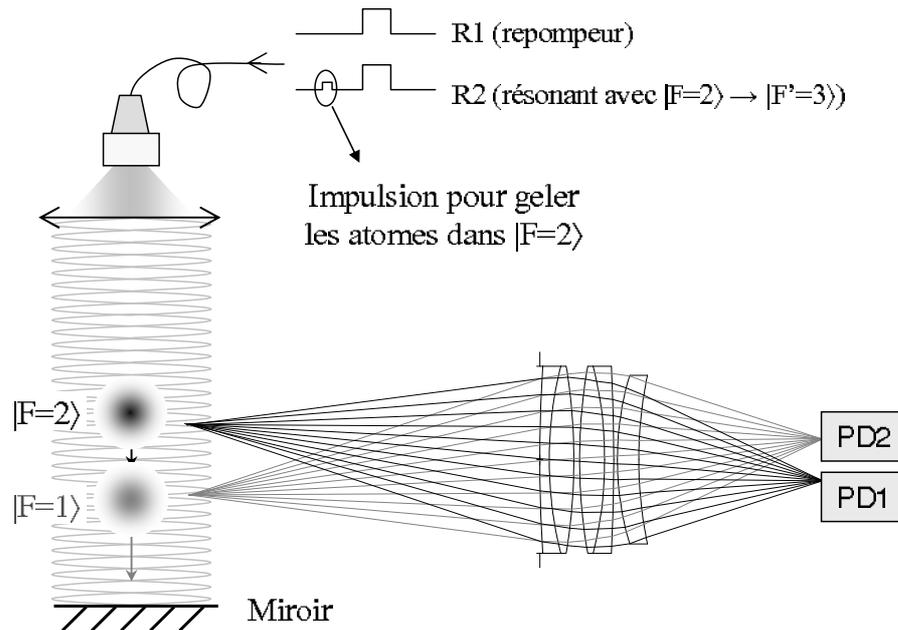
FIG. 3.9 – Schéma de principe de la détection verticale. Les atomes dans  $|5S_{1/2}, F = 2\rangle$  sont arrêtés devant la photodiode PD1 par une brève impulsion résonante, tandis que les atomes dans  $|5S_{1/2}, F = 1\rangle$  poursuivent leur chute. Une fois devant la deuxième photodiode, une impulsion intense des lasers de repompage et de détection permet une excitation très efficace des deux populations.
