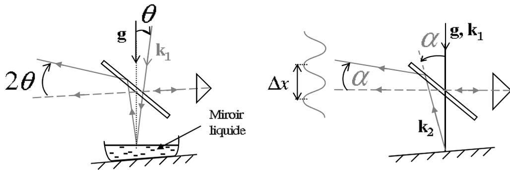
FIG. 6.14 – Méthode appliquée pour l’alignement vertical *ab initio* des faisceaux lasers. Le vecteur  $\mathbf{k}_1$  est aligné en le superposant à grande distance avec son image sur une surface parfaitement horizontale. Les vecteurs  $\mathbf{k}_1$  et  $\mathbf{k}_2$  sont ensuite alignés en cherchant la teinte plate de leur interférence.
