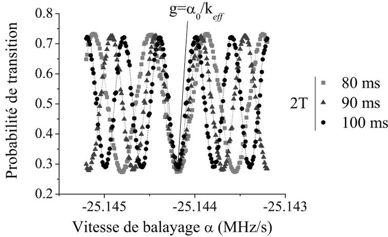
FIG. 4.4 – Systèmes de franges d'interférences du gravimètre pour trois durées d'interféromètre  $2T$ . La probabilité de transition est mesurée en fonction du taux de la rampe de fréquence destinée à compenser l'accélération des atomes, ce qui revient à balayer la phase. La frange sombre indépendante de  $2T$  indique la rampe qui compense exactement  $g$ .
