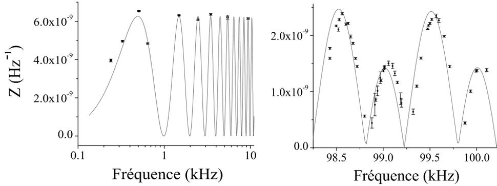
FIG. 5.8 – Calcul et mesure de la fonction de transfert pour des fréquences de modulation basses (gauche) et hautes (droite), par rapport à  $f_c \approx 24$  kHz. Pour ces mesures, la distance aller et retour entre les atomes et le miroir est de  $2L = 93$  cm.
