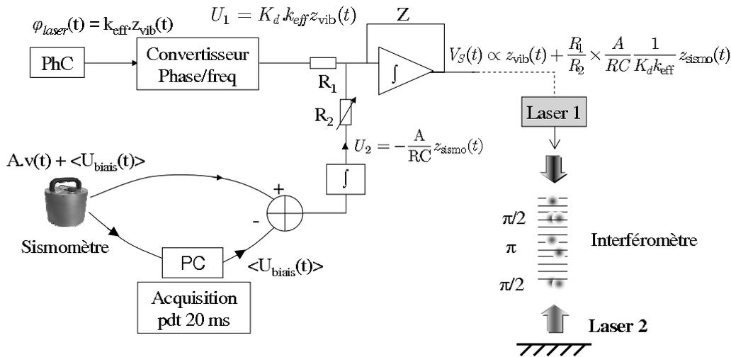
FIG. 5.16 – Principe de la compensation directe sur la boucle d'asservissement, ou *feed-forward*. Le signal de vitesse du sismomètre est intégré pour obtenir le déplacement vertical du sismomètre pendant l'interféromètre. La différence de phase est alors modifiée dans la PLL, de façon à compenser le déplacement des plans équiphases et les maintenir immobiles dans le référentiel des atomes.
