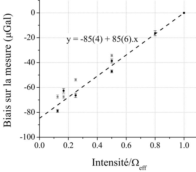
FIG. 6.16 – Influence de la fréquence de Rabi effective  $\Omega_{\text{eff}}$  sur la mesure de la demi-différence. On en déduit que le biais induit par le déplacement à deux photons vaut  $+85 \mu\text{Gal}$ .
