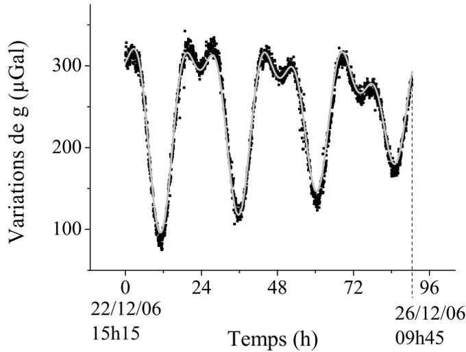
FIG. 4.12 – Mesure (points noirs) et modèle (trait gris) des marées, à Noël 2006. Un point correspond au moyennage de 100 mesures consécutives. La différence entre le modèle et la mesure fluctue de  $\pm 15 \mu\text{Gal}$  à l'échelle d'une journée.
