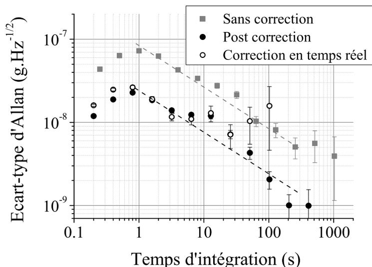
FIG. 4.9 – Comparaison des deux méthodes de réjection du bruit de vibration. La stabilité est de  $7 \cdot 10^{-8} \text{ g}$  sans correction, et de  $2,5 \cdot 10^{-8} \text{ g}$  avec les deux corrections.
