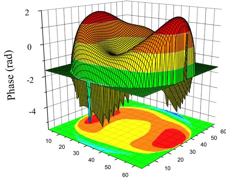
FIG. 6.21 – Surface de phase du faisceau Raman, après la traversée des hublots de l’enceinte à vide. En supposant que la déformation due au hublot du haut est négligeable, on peut considérer que la phase imprimée sur les atomes est le double de l’intégration de ce profil sur la distribution en vitesse du nuage.
