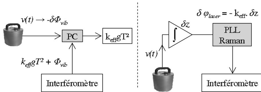
FIG. 4.8 – Schémas des deux méthodes de réjection. La correction *a posteriori* (gauche) consiste à calculer avec l'ordinateur, une fois la mesure effectuée, le déphasage induit par les vibrations (intégrées sur la durée de l'interféromètre). Dans le traitement en temps réel (droite), le signal de vitesse mesuré par le sismomètre est intégré pendant la mesure, et cette correction est directement soustraite à la phase des lasers.
