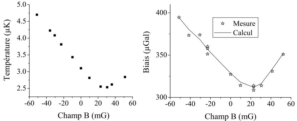
FIG. 6.26 – Gauche : variation de la température en fonction du champ magnétique horizontal  $B_h$  dans la mélasse. Droite : mesure de l’influence du champ  $B_h$  sur le biais (étoiles). La courbe théorique (trait noir) est tirée de l’équation 6.43, en tenant compte de l’effet de  $B_h$  sur la dispersion en vitesse (courbe de gauche), avec les paramètres  $\chi = 70 \mu\text{m/s/mG}$  et  $K = 25000$ .
