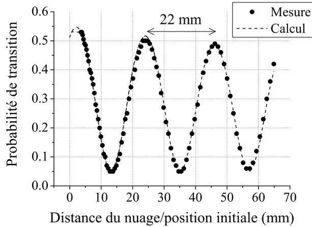
FIG. 4.3 – Probabilité de transition en fonction du délai entre le lâcher et une transition Raman  $\pi/2$  ( $\tau = 8 \mu\text{s}$ ). La période mesurée correspond bien à la valeur théorique  $\lambda_{\text{HFS}}/2 = 21,945$  mm. La courbe en pointillés correspond au calcul 4.4 où  $\Omega_{\text{eff}}$  est pondéré par une gaussienne.
