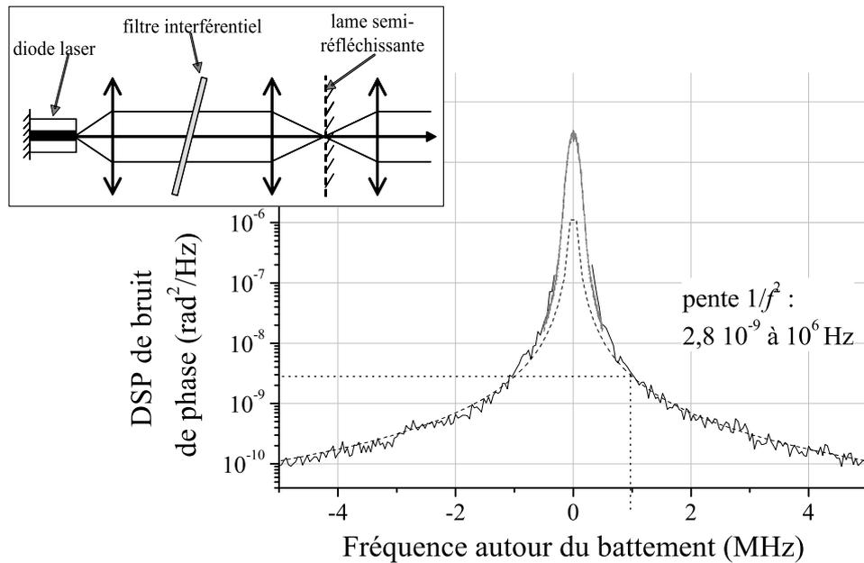
FIG. 3.1 – Densité spectrale de puissance (DSP) du bruit de phase du battement entre le laser refroidisseur et le laser repompeur. L’ajustement par un bruit blanc de phase en  $1/f^2$  permet d’en déduire une largeur du battement de 9 kHz, et donc une largeur de raie de 18 kHz pour chaque laser. La hauteur à  $1/e^2$  de l’ajustement gaussien est de 148 kHz. Encadré : schéma des cavités étendues utilisées pour les trois lasers.
