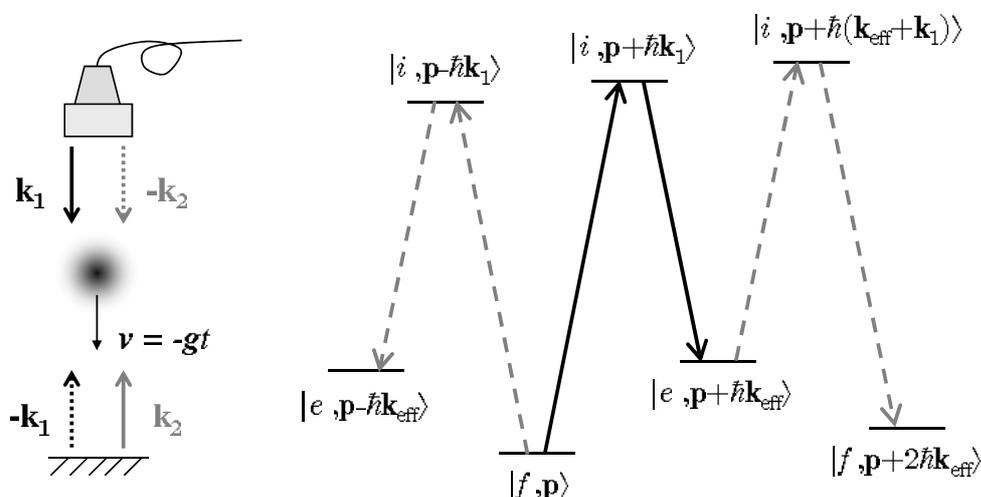
FIG. 2.4 – Gauche : les faisceaux contra-propageants (traits pleins) à résonance avec la transition  $|f, \mathbf{p}\rangle \rightarrow |e, \mathbf{p} + \hbar\mathbf{k}_{\text{eff}}\rangle$  sont obtenus par réflexion, ce qui implique la présence dans l'enceinte d'une deuxième paire de faisceaux contra-propageants, hors résonance (pointillés). Droite : schéma des niveaux d'énergie branchés par les faisceaux résonants et non résonants.
