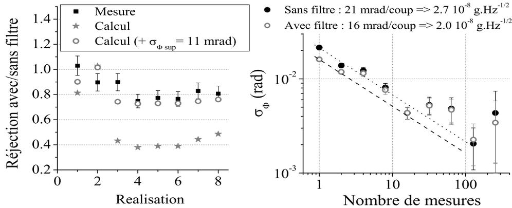
FIG. 5.25 – Gauche : taux de réjection pour différents paramètres  $f_0$ ,  $f_1$ , et  $f_c$ . Les étoiles grises représentent le taux de réjection calculé en considérant que les vibrations sont la seule source de bruit. Les mesures correspondent mieux au calcul incluant une source de bruit supplémentaire de 11 mrad/mesure (cercles gris). Droite : meilleure sensibilité observée une nuit, avec la ventilation.
