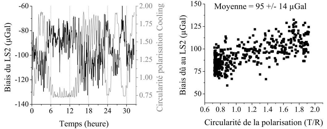
FIG. 6.17 – Influence de la polarisation des faisceaux Raman sur le biais  $\delta\Phi_{\text{LS2}}(t)$  dû au déplacement lumineux à deux photons. La circularité de la polarisation est définie comme le rapport des intensités des deux axes de la polarisation, qui doit être circulaire. La mesure simultanée (gauche) permet de montrer la corrélation entre les deux variables (droite).
