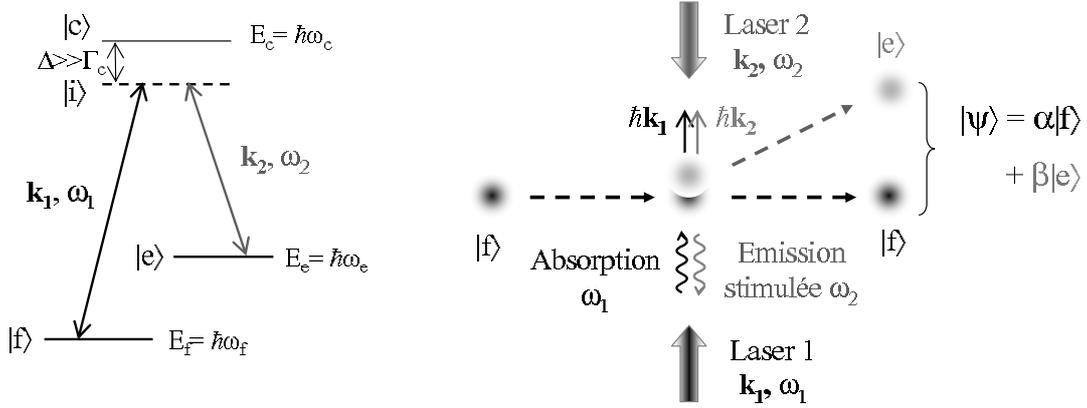
FIG. 2.1 – Gauche : diagramme énergétique en lambda d'un atome alcalin. Droite : schéma de la séparation cohérente effectuée par une transition Raman stimulée.
