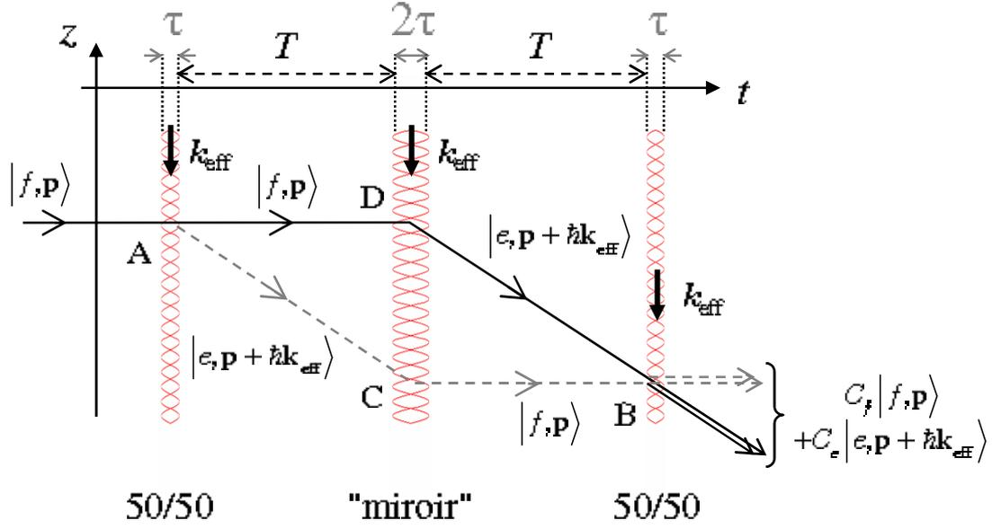
FIG. 2.2 – Schéma d'un interféromètre atomique où les ondes de matières sont séparées puis redirigées et recombinaées par des transitions Raman stimulées. Ces séparatrices lumineuses sont sélectives en vitesse et établissent donc une relation univoque entre les états d'impulsion qui forment l'interféromètre et les états d'énergie interne.
