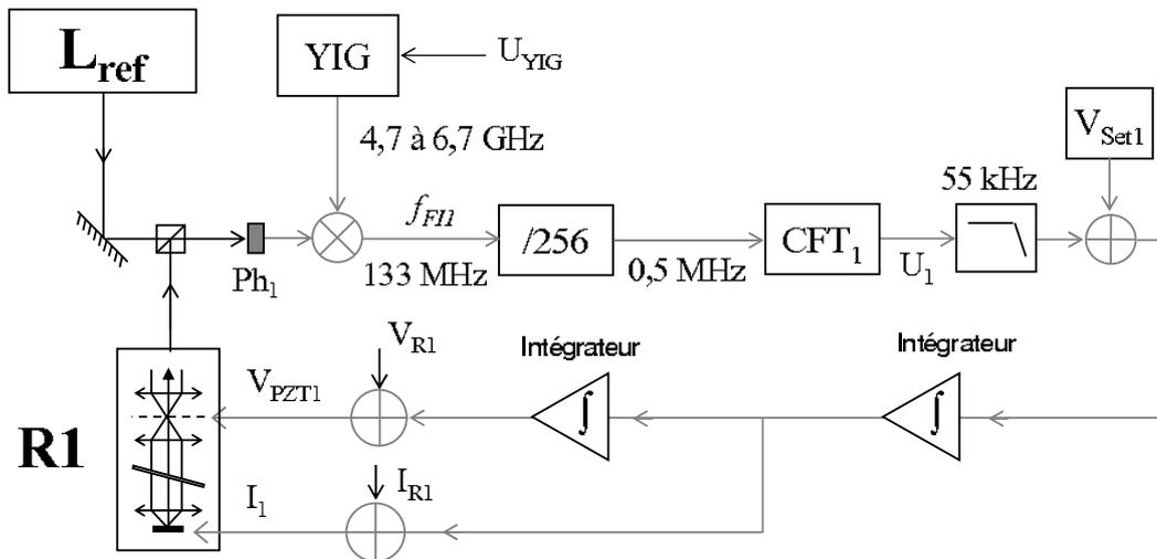
FIG. 3.12 – Schéma de la boucle de verrouillage de fréquence du laser repompeur et Raman  $R1$ . La fréquence du laser  $R1$  est comparée à celle du laser de référence  $L_{\text{ref}}$  grâce à un oscillateur micro-onde accordable. La fréquence de  $R1$  peut ainsi être désaccordée de quelques GHz en quelques millisecondes. CFT : convertisseur fréquence-tension.
