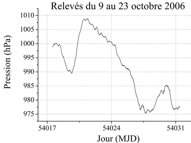
FIG. 6.29 – Variations de pression atmosphérique sur le site de Trappes, pendant deux semaines d'octobre 2006. La pression passe de 1008 hPa à 975 hPa en une semaine, induisant une augmentation de  $g$  de près de  $10 \mu\text{Gal}$ .
