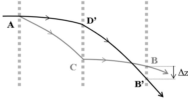
FIG. 6.30 – Trajectoires perturbées par le potentiel du à l'effet d'indice, représentées pour une valeur négative de la vitesse de recul  $v_r$ . La perturbation induit un décalage  $\Delta z \sim 10^{-12}$  m entre les deux sorties de l'interféromètre, très petit devant la longueur d'onde de De Broglie des atomes ( $\lambda_{dB} = 10^{-7}$ m). Le déphasage correspondant est calculé comme la différence entre les actions le long des deux chemins perturbés.
