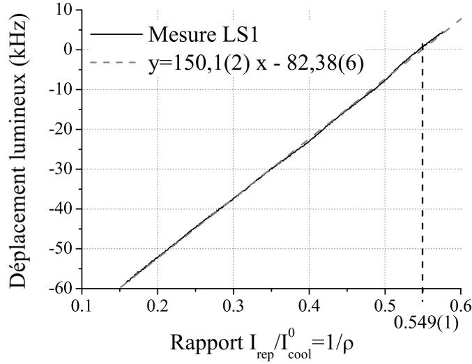
FIG. 6.1 – Mesure du déplacement lumineux à un photon en fonction du rapport des intensités des faisceaux Raman. L'intensité du faisceau  $R2$ , utilisé comme refroidisseur, est maintenue constante pour conserver un nombre d'atomes constant dans le nuage. Pour le désaccord  $\Delta = -1,3$  GHz, le rapport nominal vaut  $1/\rho = 0,55$ , soit  $\rho = 1,8$ .
