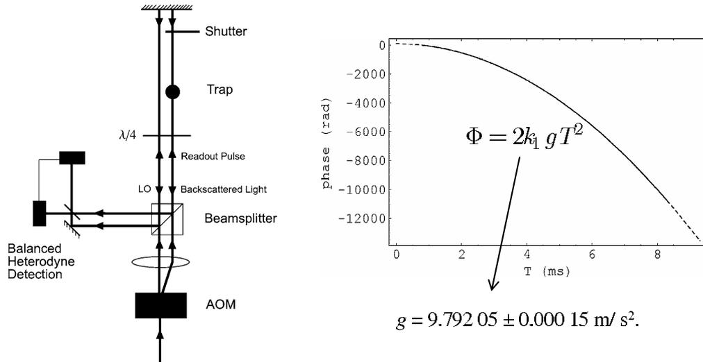
FIG. 1.4 – Mesure avec des ondes stationnaires. Deux faisceaux contra-propageants séparent les paquets d’onde, à intervalle de temps  $T$ . Après un délai  $NT + \delta t$ , une onde progressive est diffractée par le réseau atomique. Le déphasage de l’onde rétro-réfléchie est mesuré pour différentes valeurs de  $T$  (avec  $N = 1$ ), et la mesure de  $g$  est déduite d’un ajustement. (Images tirées de [35])
