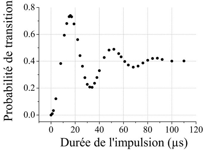
FIG. 4.1 – Oscillations de Rabi avec une paire de faisceaux contra-propageants, réalisées sur le nuage d'atomes après la sélection en vitesse. Le désaccord  $\Delta$  par rapport à la transition optique est de 1 GHz, et la durée d'une transition  $\pi$  est de  $16 \mu\text{s}$ .
