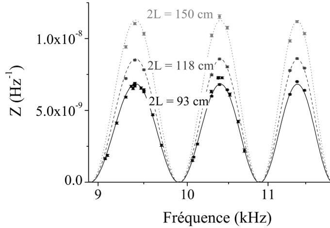
FIG. 5.7 – Fonction de transfert  $Z$  du bruit de fréquence du laser en bruit de phase atomique, pour trois longueurs de rétro-réflexion différentes. Les points expérimentaux sont en bon accord avec les courbes théoriques (voir équation 5.5).
