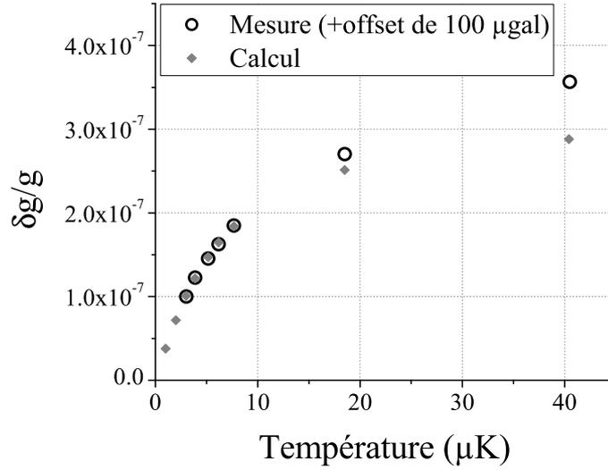
FIG. 6.19 – Influence de la température sur la valeur mesurée de  $g$ . Le calcul reproduit la saturation due à la taille finie de la zone de détection. Un rayon de courbure  $R = 250$  m (courbure  $K = 16000$ ) permet d’ajuster correctement la mesure avec le calcul pour  $T_{at} < 10$   $\mu\text{K}$ .
