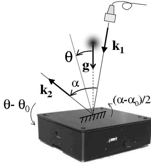
FIG. 6.13 – Le déphasage atomique mesure la projection de l'accélération  $\mathbf{g}$  subie par les atomes sur le vecteur d'onde effectif  $\mathbf{k}_{\text{eff}}$  défini par la différence  $\mathbf{k}_1 - \mathbf{k}_2$  entre les vecteurs d'onde des lasers Raman. Les trois vecteurs doivent donc être alignés.
