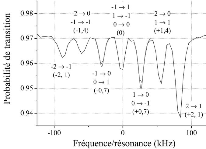
FIG. 6.3 – Spectre des transitions Raman possibles de  $F = 2$  vers  $F = 1$ , lorsqu'aucun champ magnétique n'est appliqué. Les transitions  $m_2 = i \rightarrow m_1 = j$  sont précisées avec les valeurs des décalages Zeeman linéaires entre parenthèse (en MHz/G).
