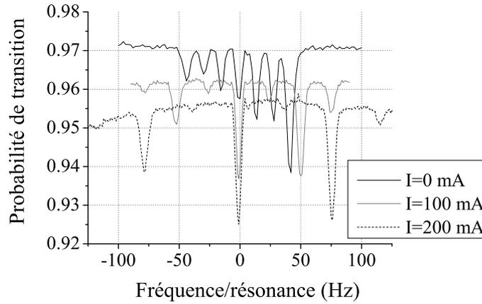
FIG. 6.4 – Spectre des transitions Raman possibles de  $F = 2$  vers  $F = 1$ , pour des valeurs croissantes du champ magnétique vertical supplémentaire (0, 100 et 200 mG). Les transitions  $\sigma$  telles que  $\Delta m_F = \pm 2$  deviennent majoritaires.
