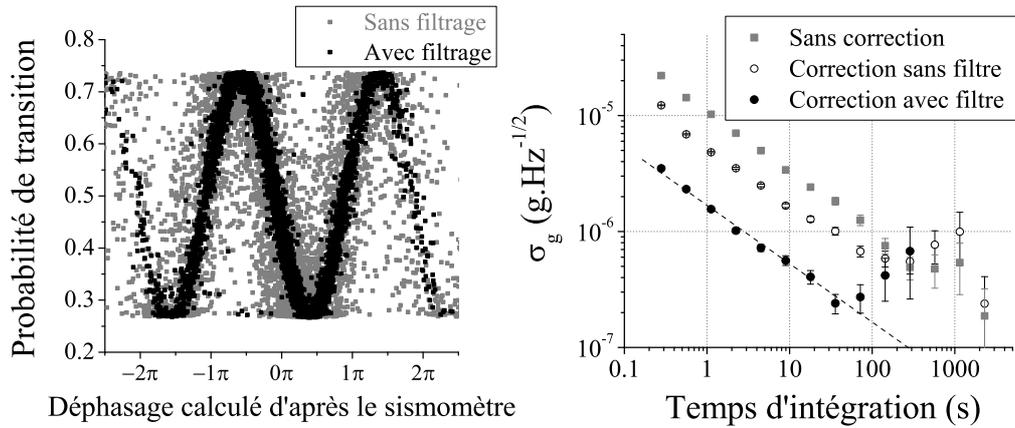
FIG. 5.27 – Gauche : Influence du filtre sur les corrélations entre la mesure du sismomètre et celle de l'interféromètre, lorsque la plate-forme est en contact avec le sol (avec  $2T = 100$  ms). Droite : Mesure à mi-frange, avec  $2T = 20$  ms. La correction simple réduit le bruit d'un facteur 2, et le filtrage apporte encore un gain de 3.
