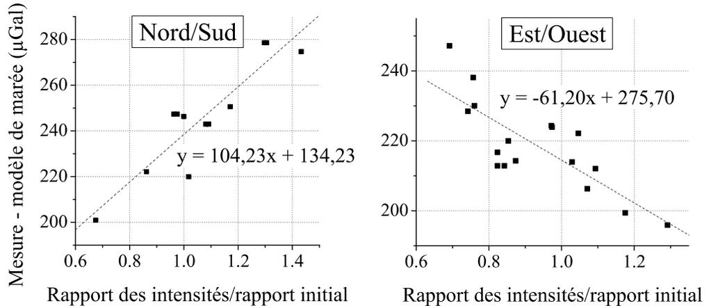
FIG. 6.24 – Différence entre le modèle de marée et notre mesure, en fonction du rapport d'intensité des bras du MOT, dans la direction Est/Ouest (sensible à l'effet Coriolis), et dans la direction Nord/Sud. Le rapport 1 correspond au réglage usuel du rapport des intensités. Les mesures sont aussi corrigées de l'inclinaison de la plate-forme.
