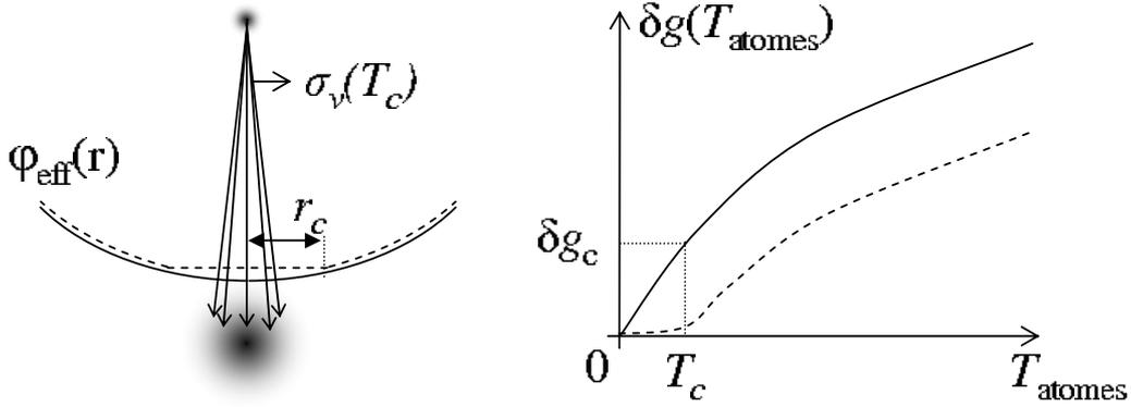
FIG. 6.20 – Exemple intuitif d’une extrapolation erronée. Tant que la température est supérieure à  $T_c$ , le nuage est plus grand qu’une zone de rayon  $r_c$ , et le biais vient essentiellement de la courbure du front d’onde. Pour une température inférieure, le nuage verrait un front d’onde parfaitement plan et le biais serait nul. Une extrapolation basée sur des mesures avec  $T > T_c$  induit donc une erreur  $\delta g_c$ .
