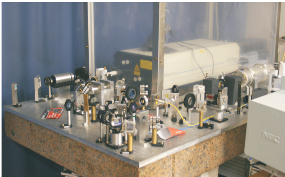
FIG. 1.21 – Photographie du deuxième laser à Ti:Sa et des éléments optiques permettant de stabiliser sa fréquence.
