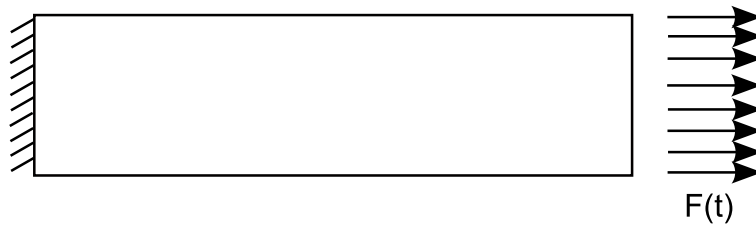
FIG. 4.6 – Description d'un essai de traction dynamique
