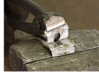
FIG. 3.2 – Exemple d'essai de pelage.
