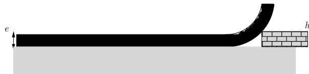
FIG. 3.3 – Expérience d'OBREIMOFF sur le mica (1930).
