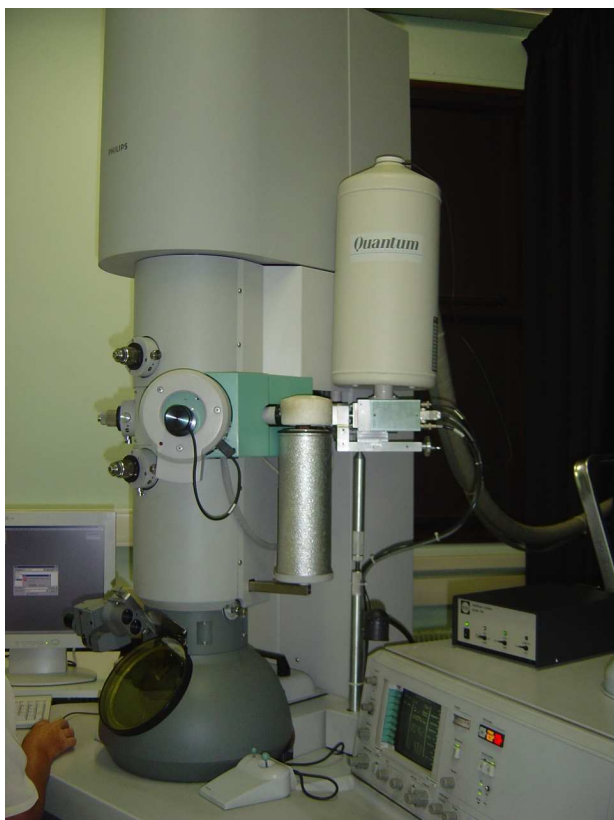
Figura 3.6 - Microscópio eletrônico de transmissão Phillips modelo CM 300 equipado com um microanalisador EDS localizado no Laboratoire de Cristallographie no CNRS de Grenoble na França
