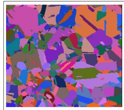
Sélection de la zone de mesure de champs grâce au plot d'or déposé à la surface de l'éprouvette et apparaissant comme amas de points non indexés sur la carte brute. Il s'agit du quart en bas à droite de l'image précédente.
