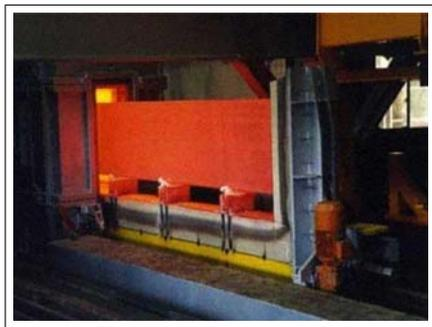
Le four présenté ici est un four électrique permettant de porter à température le lingot avant laminage à chaud.
