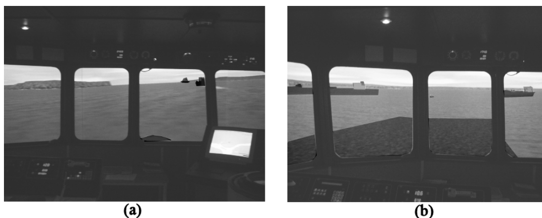
Figure 2.6 — Simulation de la passerelle (a) d'un navire école de petite taille, (b) d'un porte-avions.
