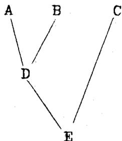
Dans l'objet E, les ancêtres sont donnés par (D, C). Sans plus de précision, les ancêtres pris en compte lors de l'héritage sont dans l'ordre: A, B, D, C. Pour éviter le parcours en profondeur, LOOPS permet d'écrire la liste des ancêtres comme suit: ( (D), C). Dans ce cas, les ancêtres utilisés sont dans l'ordre: D, C.
