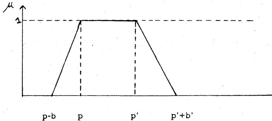
Une fonction trapézoïdale  $\mu(p \ p' \ b \ b')$  définit la distribution:
