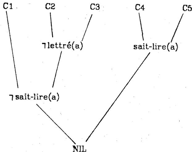
En notant  $C2 = -\text{dauphin}(X) - \text{lettré}(X)$  et  $C3 = +\text{dauphin}(a)$  on voit que la résolvante  $C2 + C3$ , avec la substitution  $(X/a)$  est bien  $-\text{lettré}(a)$  ou  $\text{lettré}(a)$ . Les autres résolutions sont construites de la même façon, jusqu'à obtenir NIL, c'est à dire la clause vide.
