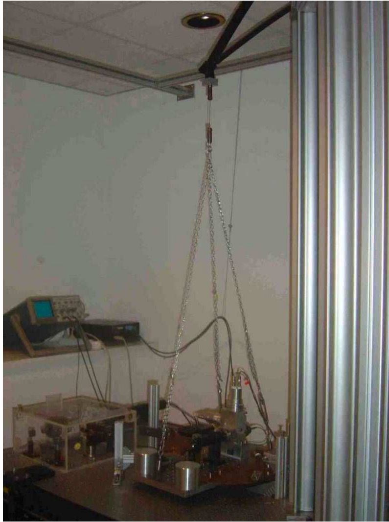
FIG. 2.5 – Photographie du dispositif d'isolation. L'interféromètre est fixé sur un plateau en Dural relié à deux tiges d'acier en flexion via des chaînes et un fil de torsion. Ces barres d'acier sont encastrées à 1.5 m au-dessus d'une table optique via trois poutres en Dural.
