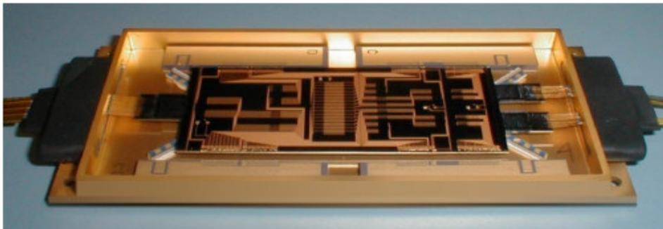
Figure 1.8 Commutateur 8x8 commercialisé par Dupont [32].
