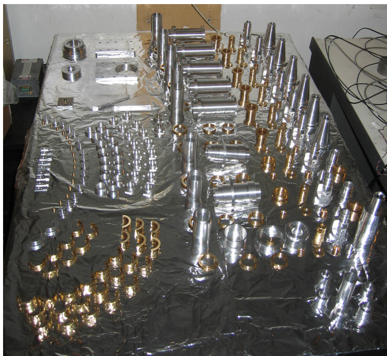
FIG. 2.36 – Les pièces des collimateurs à assembler.
