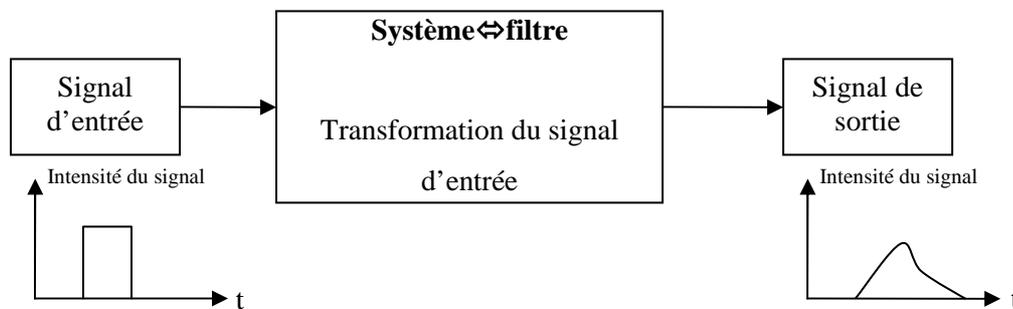
**Fig. 84: Transformation d'un signal par un système**
