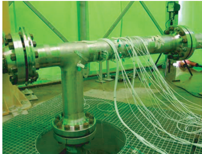
FIG. 1.12 : Éprouvette utilisée pour l'essai FATHER (diamètre des tubes : 150 mm) [Fissolo et al. , 2004]
