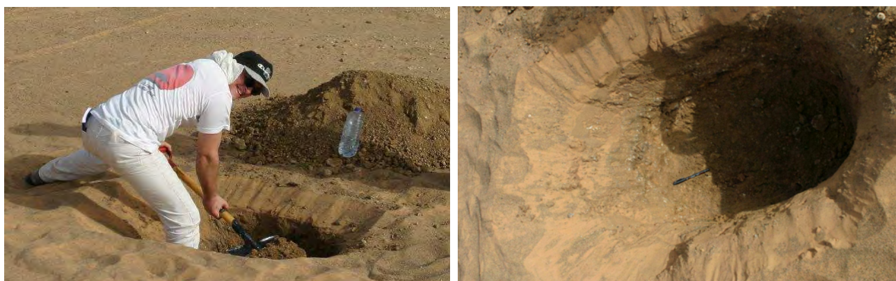
FIG. 5.12 – Analyse de la stratigraphie des dépôts présents en subsurface au niveau de l'oued. La géométrie du sous-sol se décompose en trois couches. La première correspond à une couche de sable sec et fin d'une épaisseur de 10 à 15 cm. La deuxième couche est constituée d'une matrice argileuse d'une épaisseur de l'ordre de 30 cm et contenant des grains de carbonate de taille variant entre quelques millimètres et 1 centimètre. Sous cette dernière, on constate la présence de blocs de carbonate dont la taille atteint le décimètre. Profondeur de prospection 65 cm.
