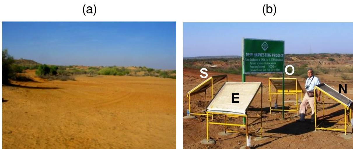
**Fig. III.15.** (a) Vue d'ensemble d'un paysage typique du Kutch (entre Nalia et Mata-Namad, sur la route joignant Panandhro à Kothara). (b) vue des quatre condenseurs standard de 1 m<sup>2</sup> (type OPUR) faisant face aux quatre directions cardinales sur le site de Panandhro (photo O. Clus).
