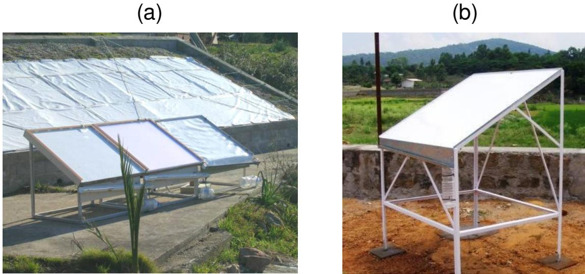
**Fig. III.1.** (a) Trois condenseurs standard sur le site d' Ajaccio (Université de Corse). De gauche à droite : peinture, Polycarbonate et Film « OPUR ». (b) détail du condenseur tôle + nouvelle peinture radiative sur le site de Yelagiri Hills (Tamil Nadu, Inde). (Photo O. Clus).
