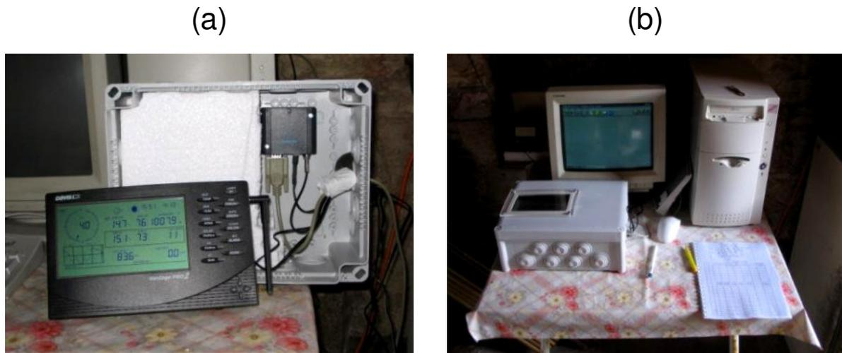
**Fig.III.5.** (a) Station météorologique et modem GSM ; (b) Le système complet de collecte et de rapatriement des données induant le PC avec sauvegarde, la liaison par modem et la station avec lecture directe et sauvegarde de sûreté sur grilles papier.
