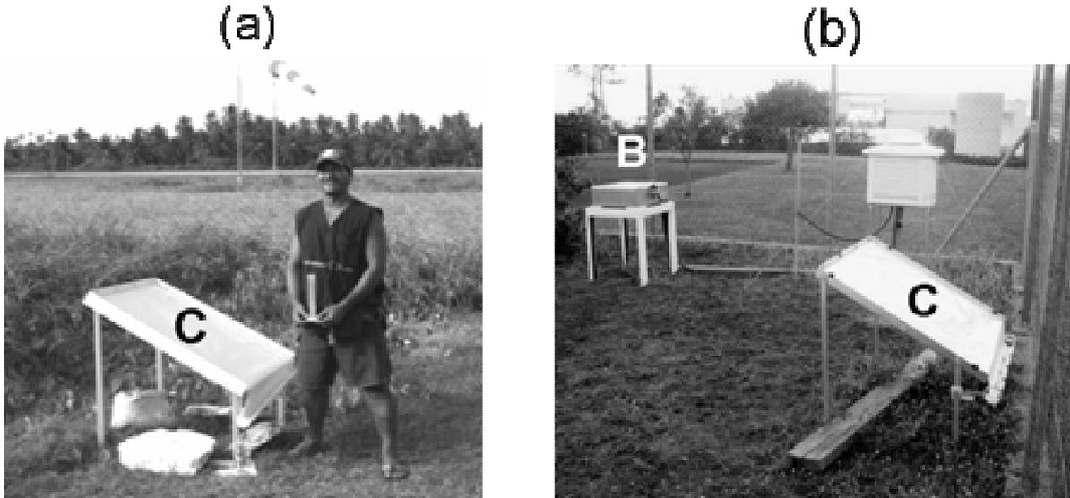
**Fig.III.9.** (a) Condenseur (C) sur le site # 1 de Tikehau. (b) Site de mesure à Tahiti. B : plaque de PTFE sur balance électronique. C : Condenseur.
