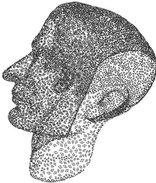
FIG. 2.25 – a) Maillage triangulé du visage (43039 points, 85145 triangles), Quadrangles retenus avec la méthode basée sur la projection (9058 quadrangles) pour un seuil S_c de 20^\circ .
