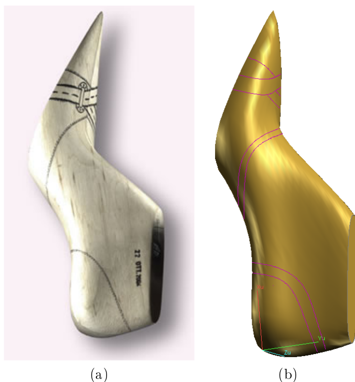
FIG. 1.11 – a) Une forme intérieure réelle avec lignes de style, b) Une forme intérieure numérique avec lignes de style.
