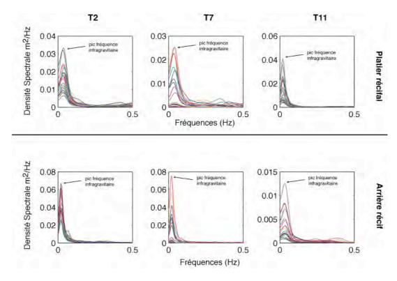
Figure V-8: Trois exemples d'analyse spectrale des variations des hauteurs d'eau enregistrées pendant l'hiver austral 2004 dans le récif frangeant de l'Hermitage / La Saline. Ces spectres illustrent la dominance des ondes infragravitaires (F<0,05 Hz) dans la répartition de l'énergie au sein du complexe récifal.
