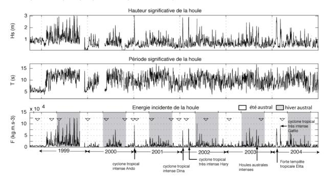
Figure III-4 : Caractéristiques de la houle enregistrée au large, hauteurs et périodes significatives, et énergie de la houle incidente à la côte. Les triangles indiquent les périodes de relevés des profils de plage.
