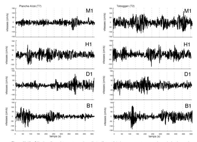
Figure V–18: Sélection d'enregistrements continus (à 1s d'intervalle) des composantes cross-shore de la vitesse des courants sur le platier récifal pour les stations de Planche Alizé (T7) et Toboggan (T2) aux phases de marée présentées en Figure V–17.
