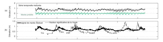
Figure 2: Représentation du signal de marée dans le complexe récifal de l'Hermitage / La Saline. (a) Marée enregistrée et marée prédite, (b) la relation entre les variations du signal résiduel et la houle océanique montre que le plan d'eau à l'intérieur du complexe récifal montre une variation du niveau moyen corrélée à la houle.
