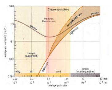
Figure VI-2: Diagramme de Hjulstrom. Relation entre les vitesses moyennes de l'écoulement et la taille moyenne du sédiment favorisant l'érosion. La classe des sables est surlignée.
