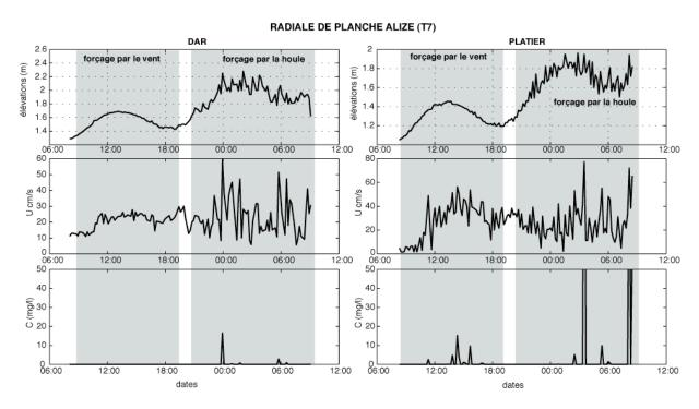
Figure VI-4: Courants moyens et calcul de concentration de MES pour la radiale de Planche Alizé lors d'un hydrodynamisme forcé par le vent puis par la houle.
