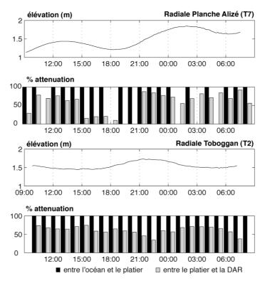
Figure V–16: Atténuation de l'énergie de la houle en fonction de la marée pour les stations de Planche Alizé (T7) et Toboggan (T2). En noir, atténuation entre l'océan et le platier récifal, en gris entre le platier récifal et la DAR
