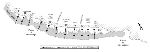
Figure V-2 : Positionnement des instruments de mesure dans le complexe récifal de l'Hermitage / La Saline.
