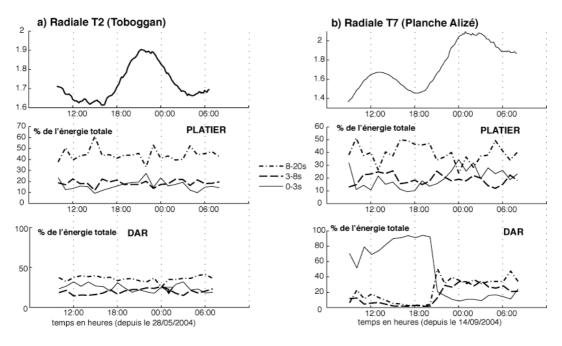
Figure V-13: Evolution temporelle de la fraction de l'énergie totale pour chaque domaine de fréquence, en régime agité pour a) la radiale de Toboggan (T2) et b) la radiale de Planche Alizé (T7).
