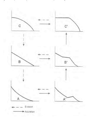
Figure III-9: Evolutions de la partie aérienne d'un profil de plage entre phases d'érosion et phases d'accrétion, d'après Sonu & van Beek (1971; in Short, 1999).
