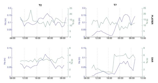
Figure V-14: Hauteurs et périodes significatives sur 24 heures, pour les radiales T2 et T7, au niveau du platier et de l'arrière récif.
