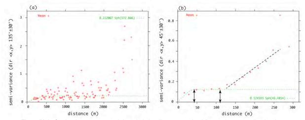
**Figure IV–8**: Semi-variogramme construit à partir de la taille moyenne du sédiment, a) pour une direction de 135° sur une distance de 3000 m, b) pour une direction de 45° sur une distance de 300 m. La tolérance sur la direction est de 30° et l'incrément des distances est de 20 m. Les courbes en pointillées représentent le meilleure modèle de variabilité spatiale ajusté au variogramme.
