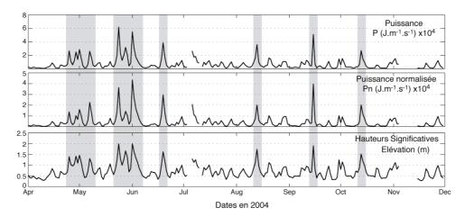
Figure V-5 : Puissance, puissance normalisée et hauteurs significatives de la houle au large. Les zones grisées correspondent à des épisodes de houle fortement énergétique.
