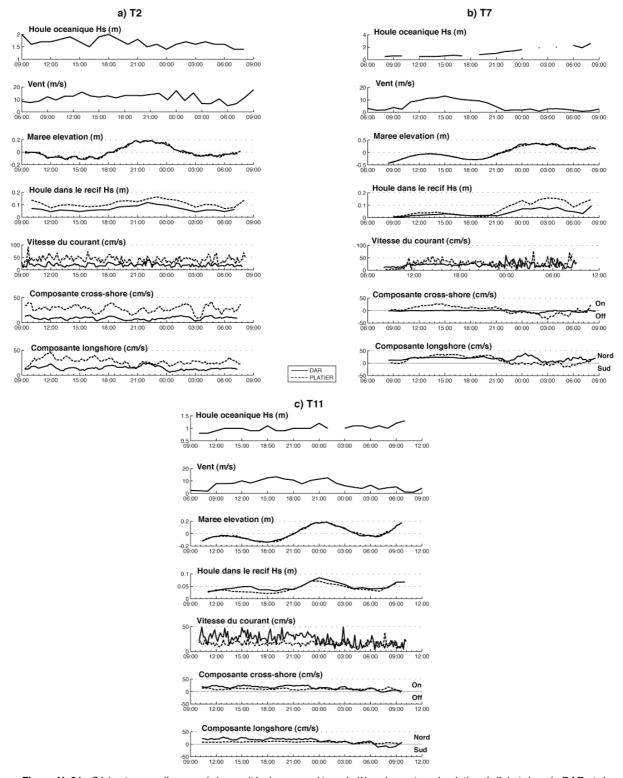
Figure V-21: Séries temporelles, en régime agité, des paramètres de l'écoulement sur le platier récifal et dans la DAR et des conditions de forçages extérieurs. a) radiale T2, b) radiale T7, et c) radiale T11. Pour les composantes cross-shore, les valeurs positives indiquent un courant vers la côte, pour les composantes longshore, les valeurs positives indiquent un courant vers le nord.
