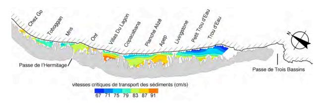
Figure VI-1 : Vitesses moyennes de l'écoulement nécessaires pour le transport des sédiments de taille présentée en Figure IV-9, Chapitre IV.
