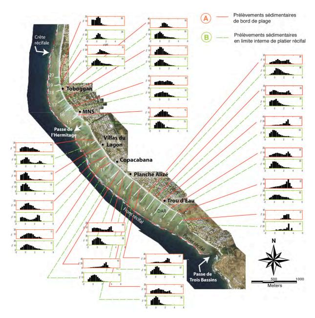
**Figure IV–6** : Distributions des échantillons sédimentaires A) situés en bas de plage, B) situés en limite interne du platier récifal. L'abscisse des histogrammes correspond aux classes de taille des sédiments exprimées en unité φ.
