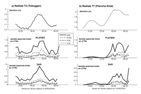
Figure V-12: Variations temporelles de l'énergie des vagues en régime agité sur 24 heures, pour a) la radiale de Toboggan (T2), et b) la radiale de Planche Alizé (T7).
