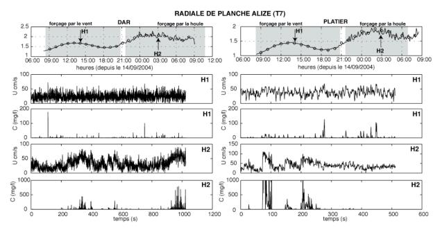
Figure VI-5: Concentration théorique en MES calculée à partir des courants instantanés enregistrés dans la DAR et sur le platier récifal, à la station de Planche Alizé pour un forçage par le vent puis par la houle.
