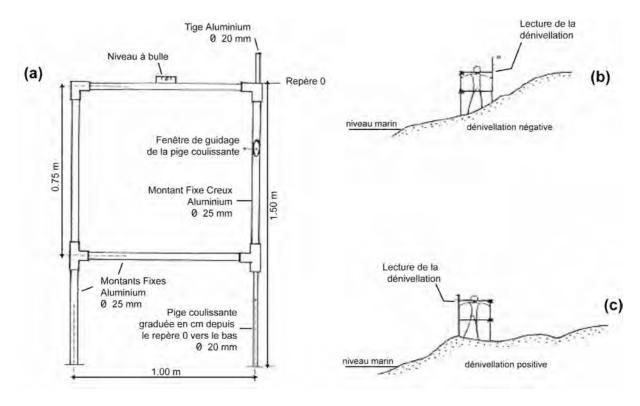
Figure III-2: Principe de mesure des profils de plage, (a) description de l'appareil de mesure, (b) principe de relevé dans le cas d'une dénivellation négative et (c) principe de relevé dans le cas d'une dénivellation positive.
