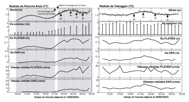
Figure V-17: Hauteurs significatives et vitesses orbitales sur le fond calculées pour les radiales T7 et T2. Les marques M1, H1, D1 et B1, indiquent les enregistrements continus (intervalle de mesure de 1s) présentés en Figure V-18.
