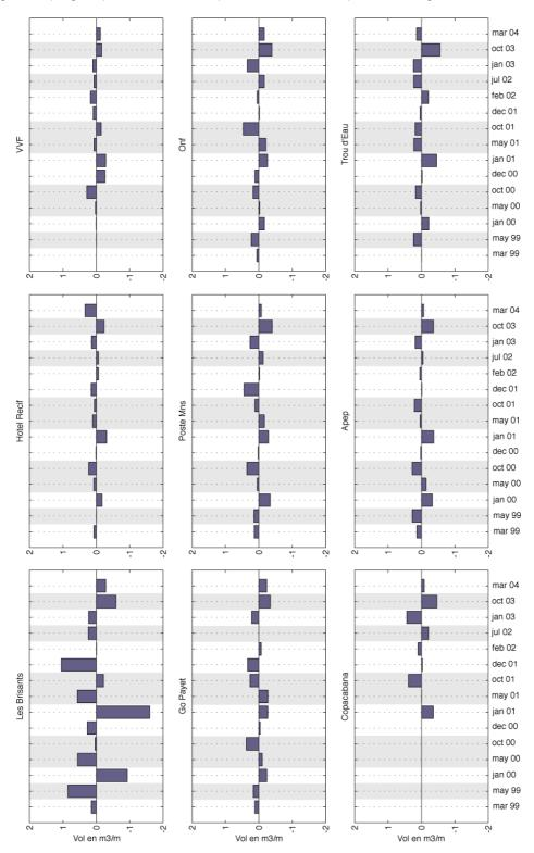
Figure III-7: Bilans sédimentaires calculés pour les neuf profils de plage. Les périodes indiquées en gris correspondent aux bilans sédimentaires calculés à la sortie de l'hiver austral.
