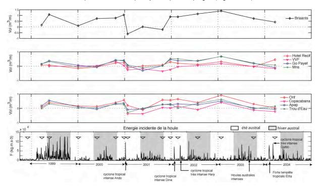
Figure III-8: Comparaison entre l'évolution des bilans sédimentaires cumulés et les flux énergétique de la houle sur la côte. La pente de la courbe entre deux points successifs détermine les phases d'érosion et d'accrétion. Si la pente est positive, il y a accrétion, si la pente est négative, il y a érosion. Une pente nulle caractérise une stabilité du profil. On remarquera l'impact particulièrement érosif du cyclone Ando en janvier 2001 sur l'ensemble des radiales.
