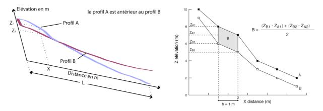
Figure III-3: Méthode de calcul des bilans sédimentaires entre deux profils successifs A et B.
