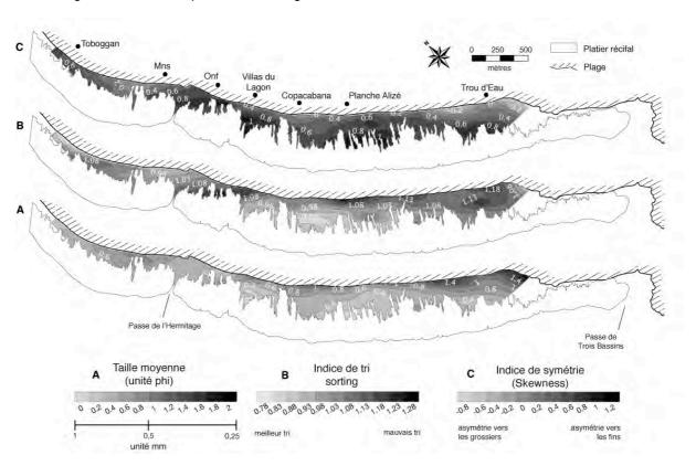
**Figure IV–9** : Cartes de contour des paramètres granulométriques interpolés, A) l'indice de symétrie Sk, B) l'indice de  $tri \sigma$  et C) la taille moyenne  $\mu$  (en unité  $\phi$ ).
