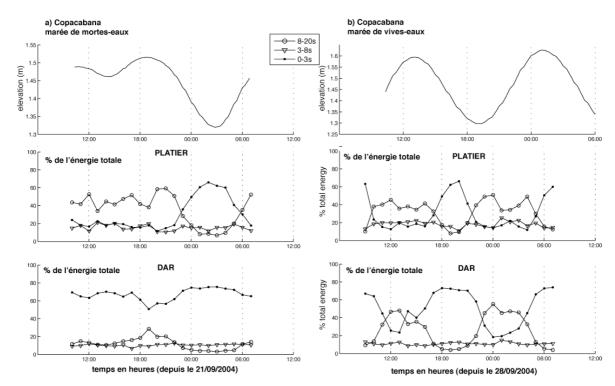
Figure V-11 : Evolution temporelle de la fraction de l'énergie totale pour chaque domaine de fréquence à la station Copacabana : a) marée de mortes-eaux, b) marée de vives-eaux.
