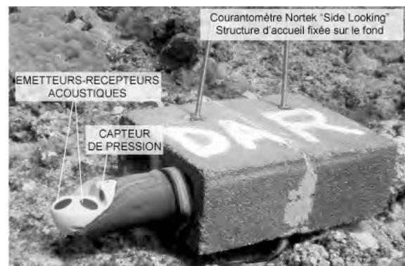
**Figure V-1** : Courantomètre nortek side-looking fixé sur le fond.
