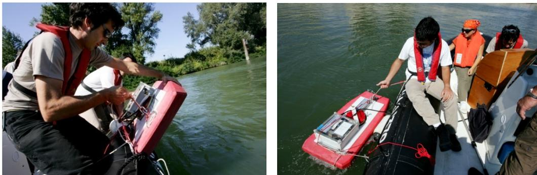
Photo 15 : Déploiement et acquisition par aDcp monté sur flotteur (Photo IRSN/Seignette)
