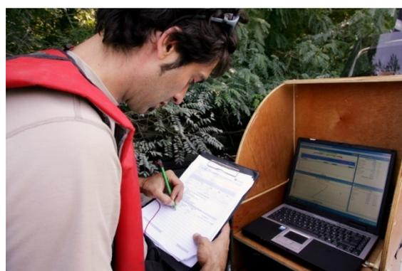
Figure 105 : Acquisition aDcp contrôlée en direct avec WinRiver (photo IRSN/Seignette)
