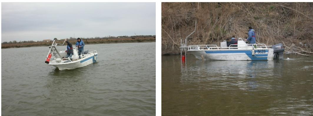
Photo 16 : Déploiement et acquisition par aDcp monté sur bras articulé (Photos Capanni, Raccasi)
