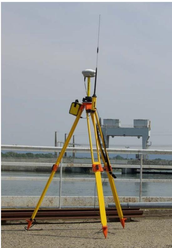
Photo 8 : Base du GPS Trimble R8 avec son antenne radio, positionnée à l'écluse de Vallabrègues
