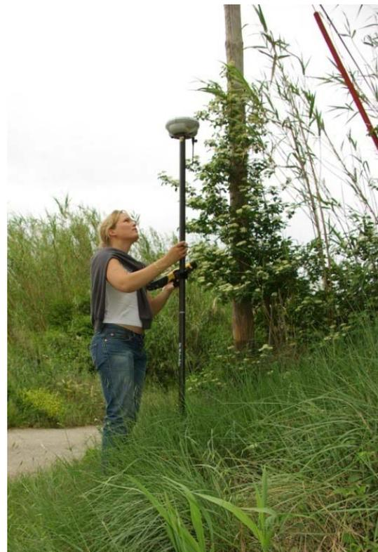
Photo 9 : Acquisition avec la station mobile du GPS Trimble R8
