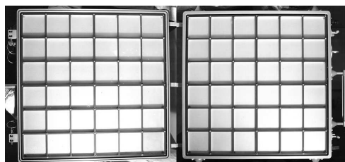
Figure 2.5 – Collecteur d'aérogel de l'expérience ODCE de la NASA présentant une surface de 0,63 \text{ m}^2 , chaque cellule contenant un bloc d'aérogel de densité 0,02 \text{ g.cm}^{-3} .
