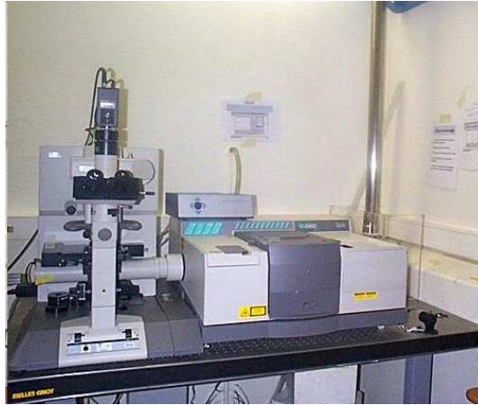
Figure 2.2 – Microscope IR (à gauche) couplé au spectromètre à Transformée de Fourier (à droite).
