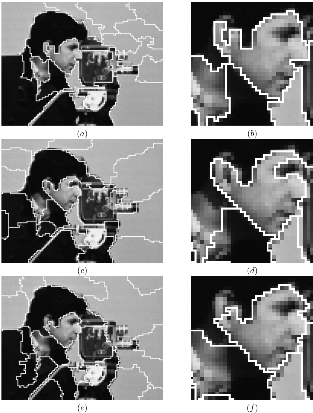
FIG. 4.8 – Coupure par LPE appliquée à une image réelle. Les LPE obtenues après filtrage [voir texte] sont superposées en blanc aux images initiales. (a, b) Coupure par LPE; (c, d) Détecteur optimal de contours de Deriche et LPE inter-pixel; et (e, f) Gradient morphologique et LPE inter-pixel. Pour chaque image, la résolution a été doublée pour pouvoir superposer les contours.
