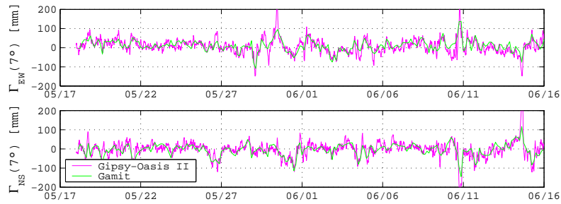
FIG. 12.15 – Comparaison des retards estimés par Gamit (vert) et Gipsy-Oasis II (magenta) pour la station XP51. Les traitements GPS sont décrits dans le tableau 12.6.
