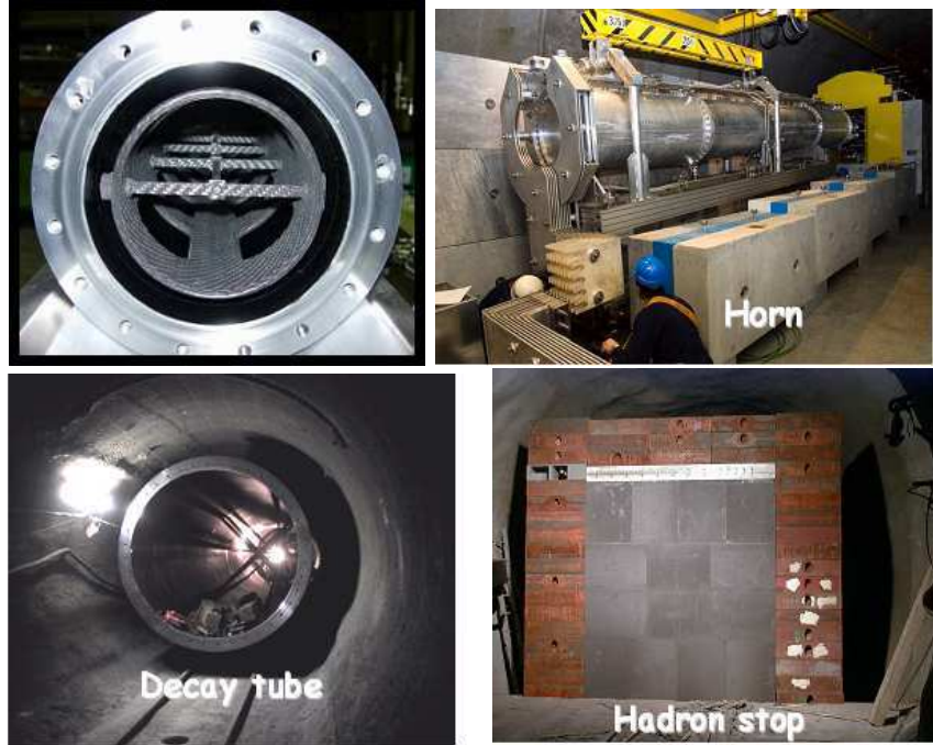
FIG. 2.4 – Photos des différentes parties du CNGS ; en haut : à gauche la cible de graphite, à droite une corne ; en bas : à gauche le tube à désintégration, à droite le stoppeur de hadrons
