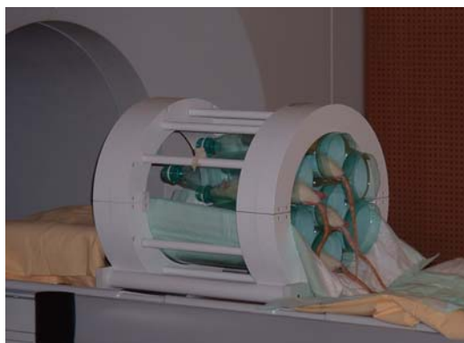
Figure 38 : Antenne radiofréquence adaptée à l'imagerie du rat
