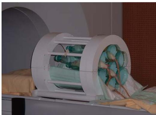
Figure 38 : Antenne radiofréquence adaptée à l'imagerie du rat
