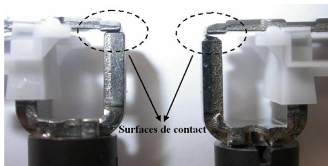
Figure 29 : Comparaison relais avec et sans rectification
