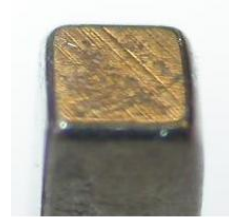
Figure 28 : Petite surface polaire après rectification
