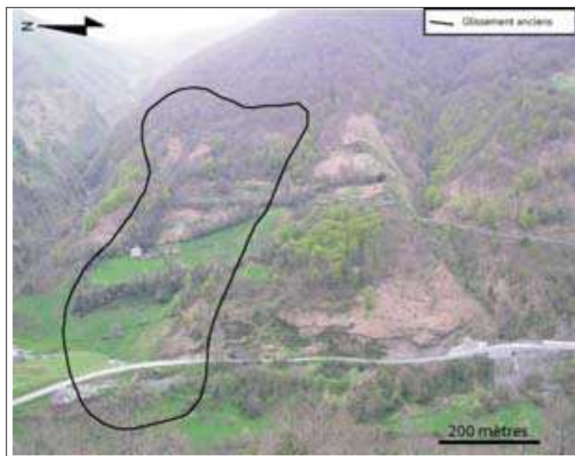
Figure 19 : Photographie du versant de Gouetsoule montrant les limites de l'ancien glissement de terrain.
