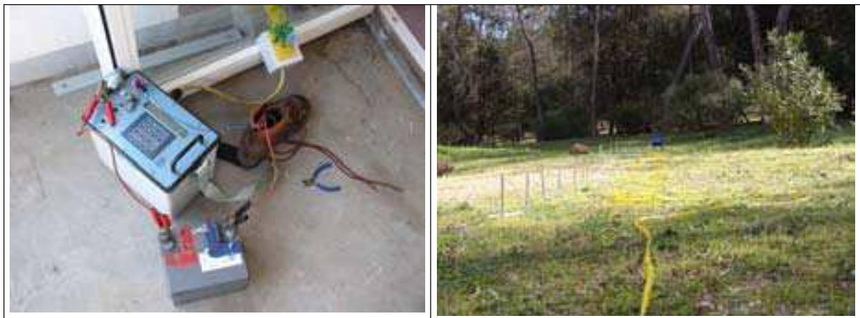
Figure 130 : Mise en place d'un profil électrique multiélectrodes. Le résistivimètre (à gauche) et la ligne électrique (à droite). (Photo Jomard H.)
