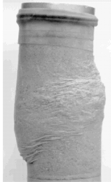
FIG. 2.24 – Photographie de l'échantillon testé à l'essai triaxial pour S_f et pour \sigma_r = 10 kPa ( \phi = 70 mm).
