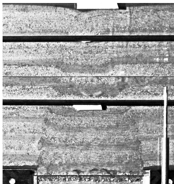
FIG. 2.34 – Photographie de la zone d'expansion du massif glissant durant la phase transitoire (cas S_f , h = 0.30 m, \delta = 40 mm).
