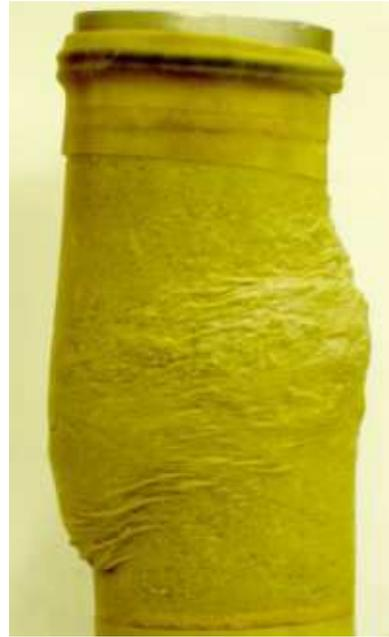
FIGURE 2.24 – Photographie de l'échantillon testé à l'essai triaxial pour  $S_f$  et pour  $\sigma_r = 10$  kPa ( $\phi = 70$  mm).
