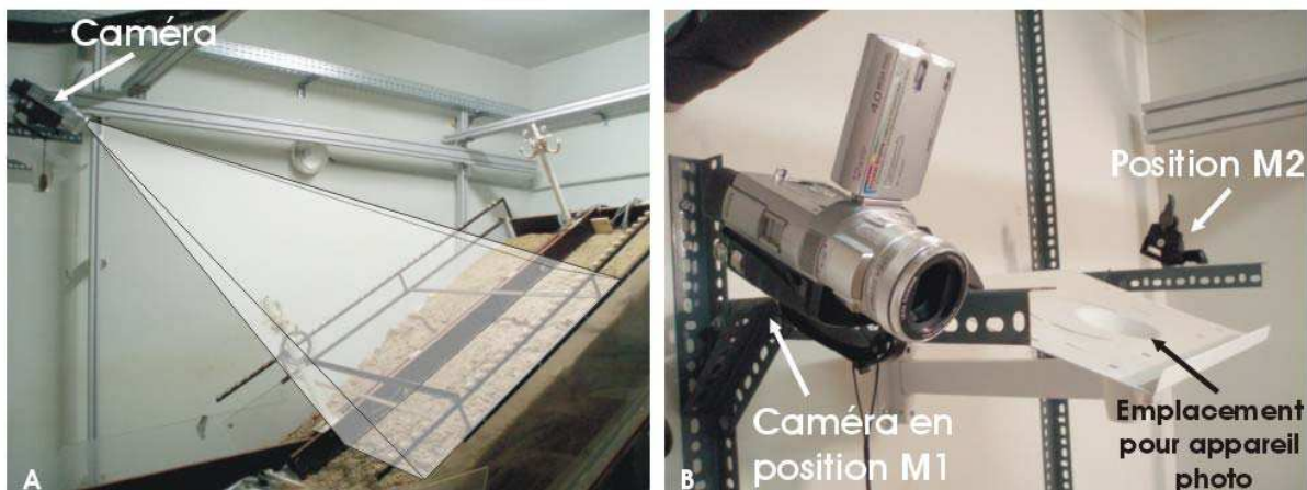
Figure IV- 28 : Positions des systèmes d'acquisition photo et vidéo. Location of cameras above the models
