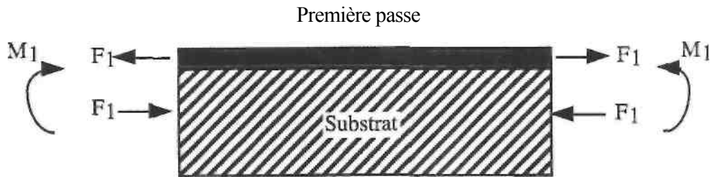
Figure III-3 : Schéma de la génération de la paire de forces égales et opposées et du moment de déséquilibre dans l'ensemble dépôt substrat.
